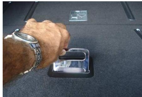
Entfernen Sie den Deckel des Bodens (erste Abdeckung).
