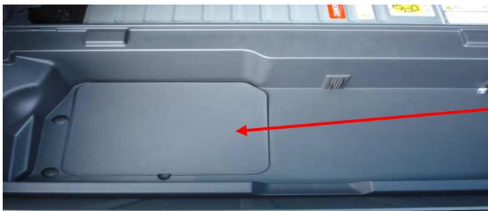
Entfernen Sie die dritte Kunststoffabdeckung (Zugangsklappe).
