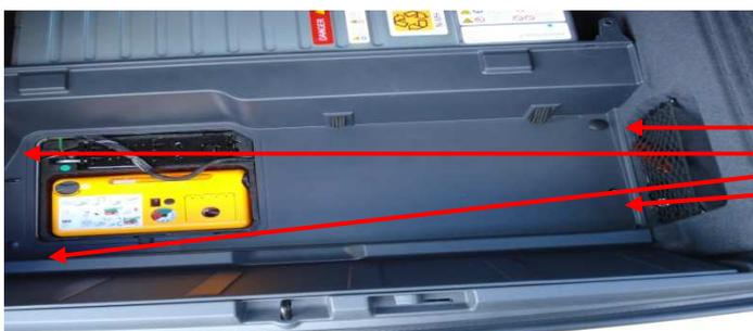
Entfernen Sie die 4 Kunststoffschrauben, und entfernen Sie die vierte Abdeckung.
