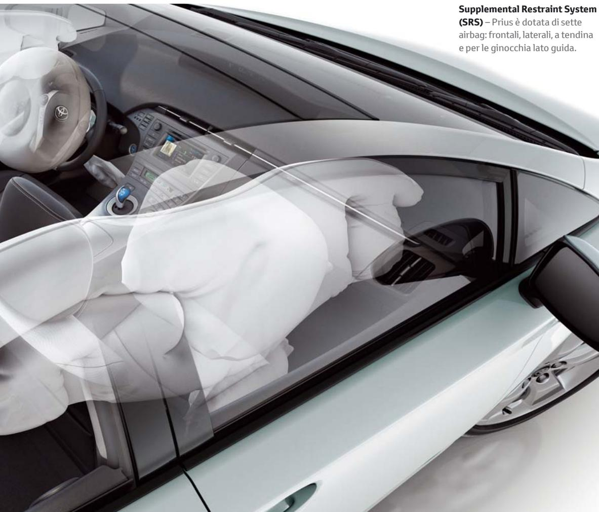
**Supplemental Restraint System (SRS)** – Prius è dotata di sette airbag: frontali, laterali, a tendina e per le ginocchia lato guida.
