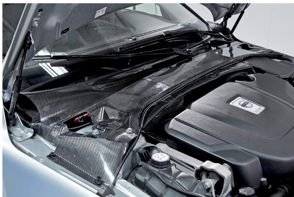
Il pannello strutturale che incorpora lo storage energetico montato in via sperimentale sulla Volvo S80
