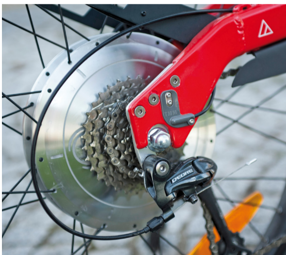
Il motore della Hybrid 24 è montato posteriormente, con un grande volano, sul mozzo della ruota. Cassetta pignoni e cambio sono Shimano Deore a 8 rapporti
