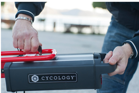
L'estrazione della batteria, come si vede dall'immagine, avviene in modo facile e veloce girando la chiavetta in dotazione e facendo scorrere la batteria su una slitta metallica integrata nel telaio. Procedura inversa, invece, per il suo riposizionamento
