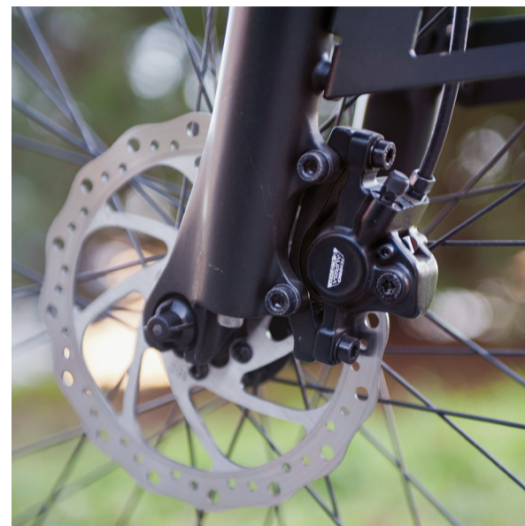
La frenata sulla Hybrid 24, sia sulla ruota anteriore che posteriore, è assicurata dai freni a disco Tektro Auriga E-Comp
