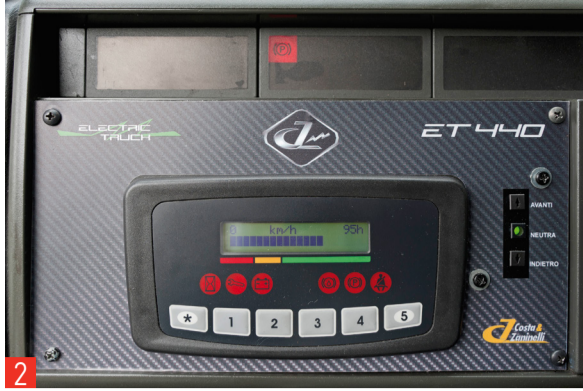
2 Dettaglio del cruscotto che è una vera e propria consolle da cui si possono variare una serie di parametri di guida impostando differenti profili utenti che possono essere richiamati facilmente
