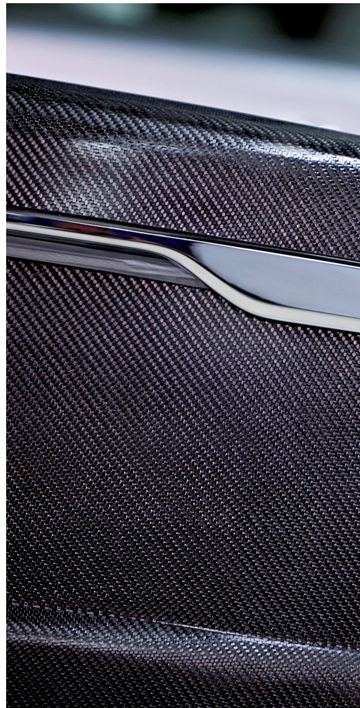
Il pannello strutturale che incorpora lo storage energetico montato in via sperimentale sulla Volvo S80
