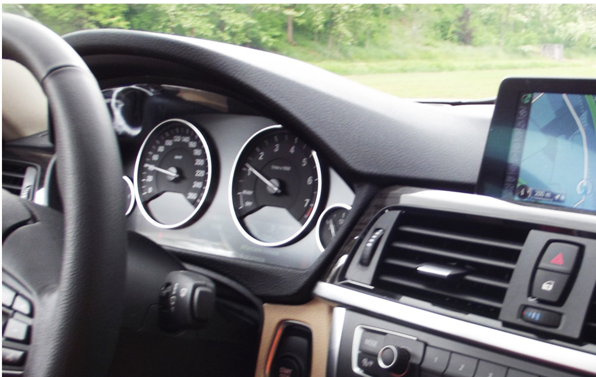
Consolle centrale con navigatore, due bocchette dell'aria, i comandi per regolare l'impianto stereo e il climatizzatore bi-zona
