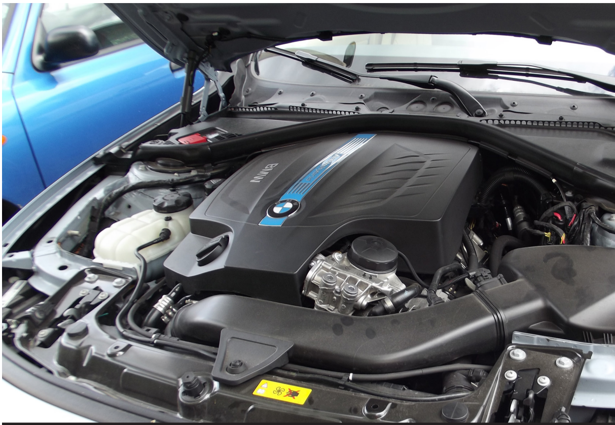
Sotto il cofano è alloggiato un motore sei cilindri in linea, dotato di tecnologia TwinPowerTurbo, abbinato a un'unità elettrica e a un cambio automatico a otto rapporti
