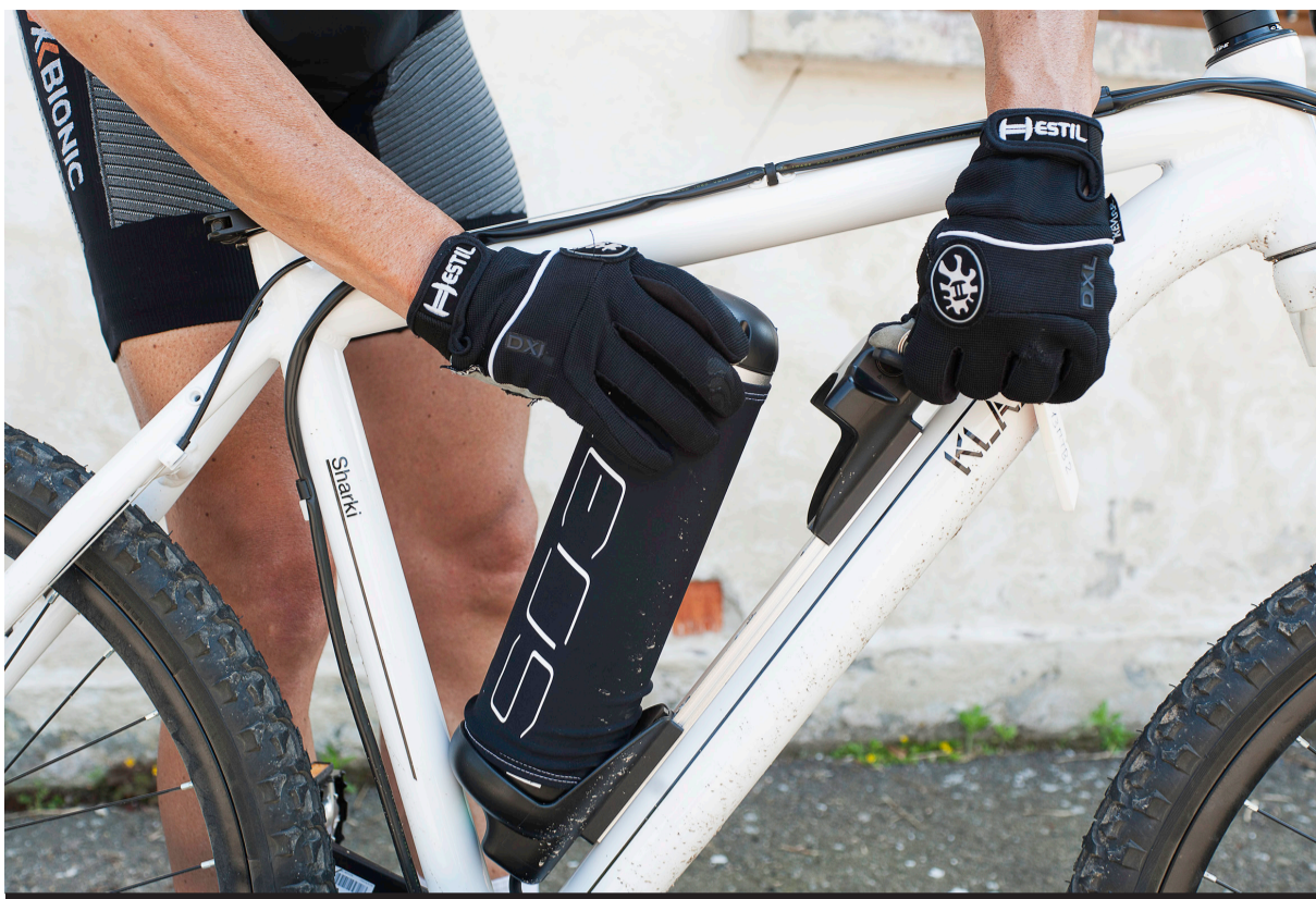
La batteria estraibile posizionata sul tubo obliquo
