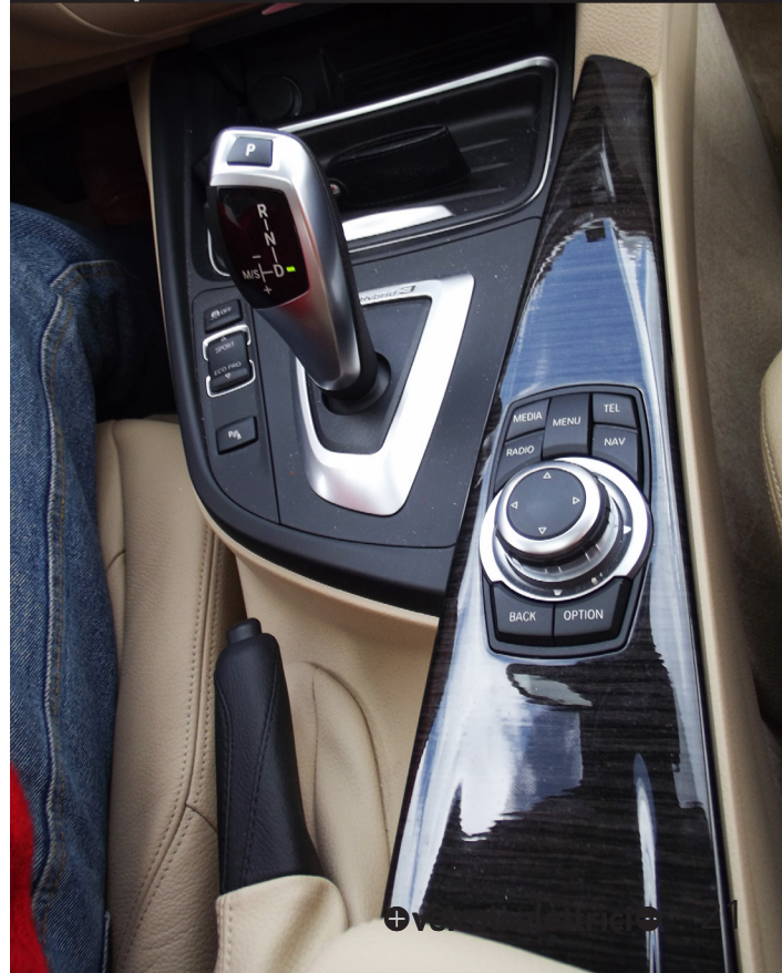
Sul tunnel sono alloggiati i tasti di selezione della modalità di marcia, il selettore del navigatore e dell'impianto di infotainment e il cambio
