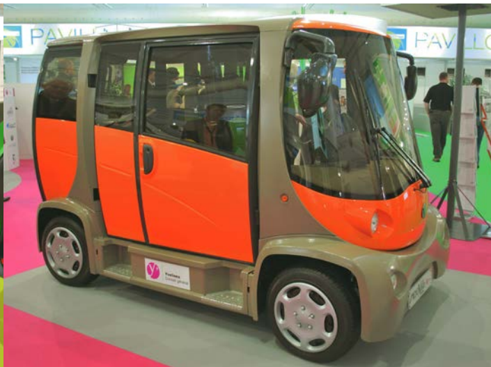
3AINDUSTRIES Questo prototipo si chiama Moduleo e permette di passare da una compatta due posti a una più comoda quattro posti semplicemente allungando la carrozzeria telescopica.
