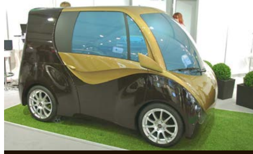
3AINDUSTRIES Questo prototipo si chiama Moduleo e permette di passare da una compatta due posti a una più comoda quattro posti semplicemente allungando la carrozzeria telescopica.
