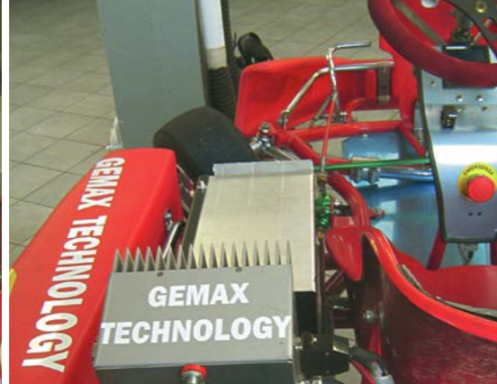
Eugenio Lissoni mostra al nostro tester il kart elettrico. Nell'ordine: l'elettronica del kart Gemax; un particolare del motore a corrente alternata che equipaggia il Kart elettrico, posto immediatamente dietro il sedile del pilota. A destra la protezione di sicurezza (in colore rosso); in mezzo il contenitore degli accumulatori ai polimeri di litio; vista posteriore, semicoperto si può scorgere il motore e a sinistra la scatola che contiene l'elettronica con le varie connessioni agli organi «vitali».
