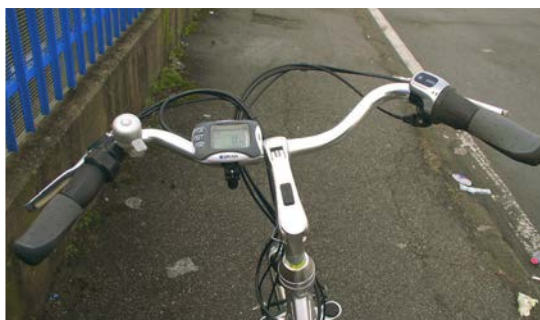
In queste foto la simpatica linea della E-Green, il manubrio con acceleratore, computer e selettore del cambio, il cambio Shimano sulla ruota posteriore.
