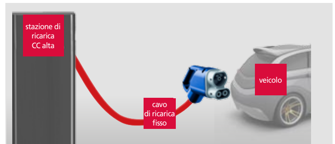
La ricarica alta in CC consente potenze di carica fino a 170 kW.
