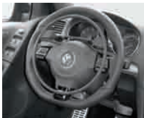
Acceleratore elettronico a cerchietto sopra il volante e freno di servizio a leva.
