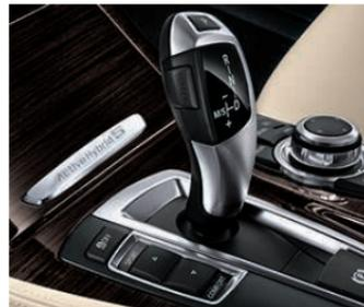
Il **pulsante di selezione della modalità di guida** permette di commutare su ECO PRO. Se questa modalità è attiva e il conducente solleva il piede dall'acceleratore, la trasmissione interrompe l'erogazione di potenza al motore a combustione che viene spento, permettendo alla BMW di scivolare silenziosamente sulla strada fino alla velocità di 160 km/h (fino a 80 km/h nell'altra modalità).
