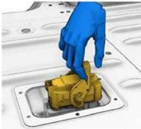
**Nota:** Quando si rimuove la spina di servizio, si interrompe fisicamente il pacco batteria impedendo il flusso di corrente.
