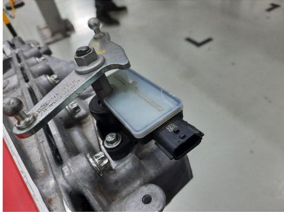
Sul motore 5AQ, il sensore è fissato con 2 bulloni, quindi non è necessaria alcuna regolazione quando si sostituisce questo sensore. La selezione è guidata da scanalature e dal punto piatto di indicizzazione.
