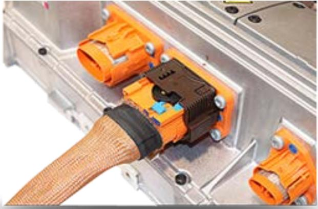
Figura 1: Intervallo di corrente massimo: 230 A
