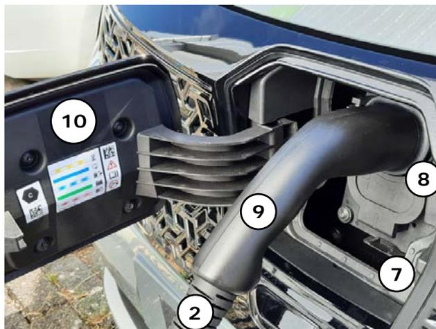
Il cavo può essere caldo subito dopo una lunga carica della batteria di trazione. Utilizzare le maniglie. Dopo aver premuto il pulsante di sblocco del cavo di ricarica, si hanno 30 secondi per scollegarlo prima che si blocchi nuovamente.
