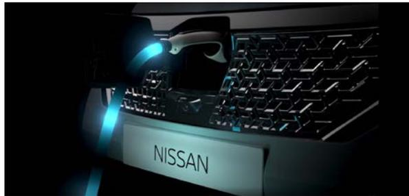
Il principio del caricabatterie Caméléon™ è semplice: gli stessi componenti che azionano il veicolo vengono utilizzati anche per caricare la batteria. In questo modo si elimina la necessità di un costoso caricabatterie a corrente continua.
