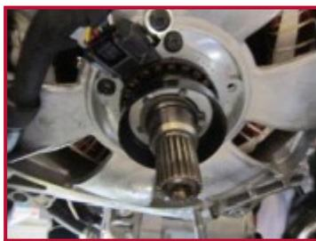
Albero del rotore con scanalature
