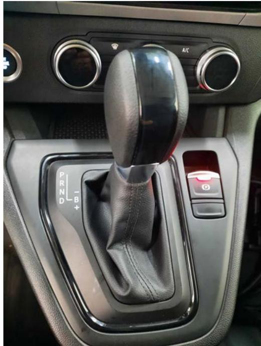
Sul gruppo della leva del cambio all'interno del veicolo è presente un blocco del cambio manuale per far uscire l'auto dalla posizione di parcheggio (P) in caso di guasto elettrico. Innanzitutto, è necessario rimuovere il coperchio fissato alla leva del cambio. Quindi, premendo il quadratino bianco, si passa dalla posizione di parcheggio a quella di disattivazione.
