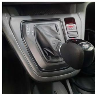
Per selezionare le modalità di rigenerazione, la leva del cambio deve essere inizialmente in modalità Drive "D". Successivamente, deve essere tirata verso destra, come quando si seleziona una "modalità sequenziale" su un cambio DCT o AT.
