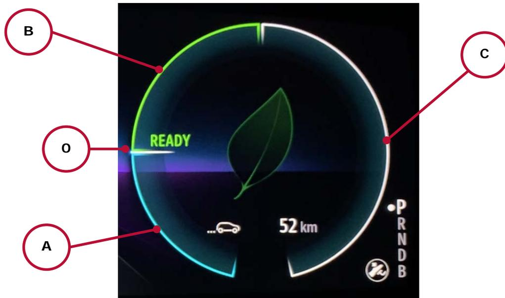
Il contatore di carica fornisce al conducente una visione in tempo reale del recupero o del consumo di energia del veicolo.
