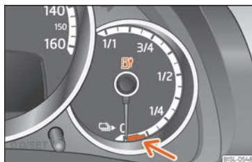
Fig. 149 Nel cruscotto: indicatore dello stato di carica della batteria ad alta tensione con l'area di riserva contrassegnata in rosso (freccia).
