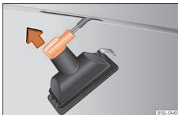
Fig. 55 Luce della targa: rimuovere il portalampada.
