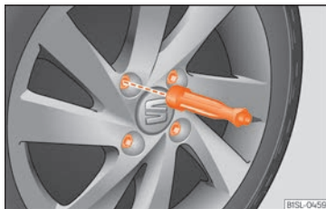
Fig. 37 Cambio di una ruota: allentare i bulloni della ruota con l'impugnatura del cacciavite.
