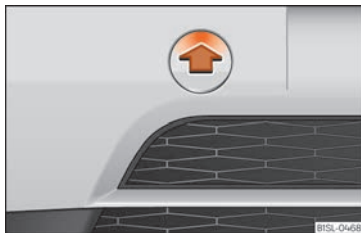
Fig. 42 Paraurti anteriore destro: rimuovere il coperchio.
