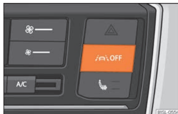
Fig. 142 Nella console centrale: tasto per collegare il dispositivo di assistenza per il mantenimento della corsia
