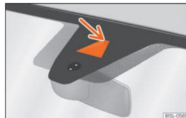
Fig. 141 Nel parabrezza: area del campo visivo del dispositivo di assistenza per il mantenimento della corsia.
