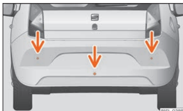
Fig. 144 Sensori di controllo del parcheggio nel paraurti posteriore.
