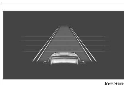
Indica che il sistema non è in grado di riconoscere le linee bianche (gialle) o è momentaneamente disattivato.
