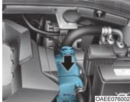
Controllare condizione e collegamenti di tutti i tubi flessibili del sistema di raffreddamento e del riscaldatore. Sostituire ogni tubo flessibile dilatato o deteriorato.
