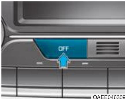
Premere il pulsante OFF per spegnere il sistema climatizzatore. Tuttavia, il modo e i pulsanti presa aria rimangono operativi fino a quando il pulsante POWER resta in posizione ON.
