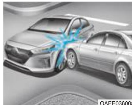
Gli airbag frontali potrebbero non gonfiarsi in caso di collisioni laterali; poiché gli occupanti vengono spinti in direzione della collisione, in caso di collisioni laterali il dispiegamento dell'airbag frontale non fornirebbe alcuna protezione supplementare all'occupante.
