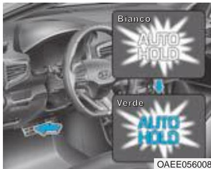
2. Quando il veicolo viene arrestato completamente premendo il pedale freno, l'indicatore AUTO HOLD cambia da bianco a verde.
