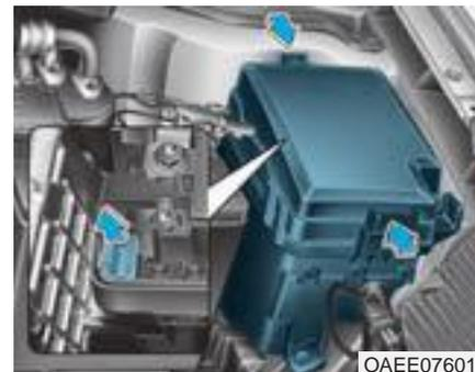
5. Estrarre il fusibile sospetto tenendolo dritto. Usare l'attrezzo estrattore presente sul pannello fusibili vano motore elettrico.
