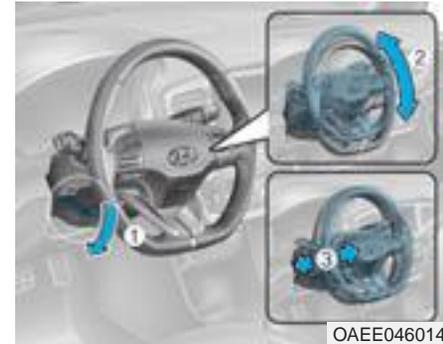
Tirare in giù la leva di blocco-rilascio (1) sul piantone del volante e regolare angolazione (2) e posizione (3) del volante. Muovere il volante in modo che punti verso il vostro torace e non verso il vostro viso.
