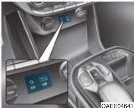
Si può usare una porta ausiliaria per collegare dispositivi audio e una porta USB per collegare un dispositivo USB e anche una porta iPod®.
