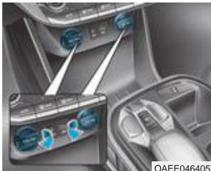
La presa di alimentazione è progettata per alimentare telefoni portatili o altri dispositivi designati per funzionare con l'impianto elettrico del veicolo. I dispositivi devono assorbire meno di 180 W (Watt) con il veicolo nel modo pronto per l'uso
