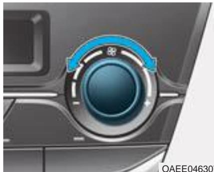
La velocità del ventilatore può essere impostata sulla velocità desiderata ruotando la manopola comando velocità ventilatore.
