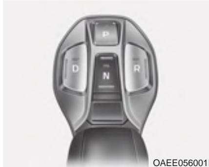
Selezionare le posizioni del cambio premendo il pulsante cambio. Per la vostra sicurezza, premere sempre il pedale freno quando si cambia ad un'altra marcia.
