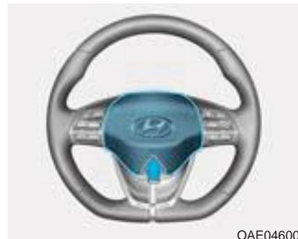
Per suonare l'avvisatore acustico, premere l'area indicata dal simbolo dell'avvisatore acustico sul volante. L'avvisatore acustico opererà solo premendo quest'area.
