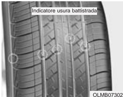
Se uno pneumatico si usura in modo uniforme, comparirà un indicatore di usura battistrada sotto forma di una banda continua che attraversa il battistrada. Ciò indica che lo spessore del battistrada rimasto sullo pneumatico è inferiore a 1,6 mm. Sostituire lo pneumatico quando ciò si verifica.
