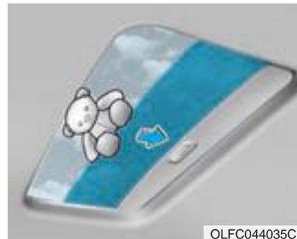
Se il tetto apribile avverte la presenza di un ostacolo mentre si sta chiudendo automaticamente, invertirà la direzione e si arresterà per consentire di rimuovere l'ostacolo.
