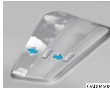
Il parasole si aprirà automaticamente con il tetto apribile quando il pannello di vetro viene movimentato. Se lo si vuole chiudere, movimentare il parasole manualmente.
