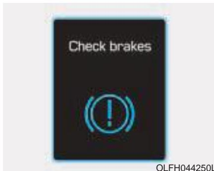
Questo messaggio spia viene visualizzato quando la funzionalità del freno è bassa o la frenata rigenerativa non funziona a dovere a causa di un guasto nel sistema freno.
