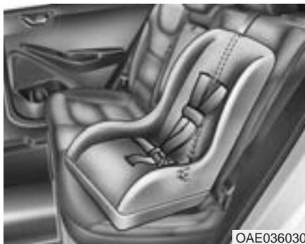
1. Far passare la cinghia superiore del sistema seggiolino per bambini sopra lo schienale sedile. Nel posizionare la cinghia superiore, seguire le istruzioni fornite dal costruttore del sistema seggiolino per bambini.
