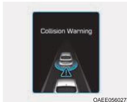
Questo messaggio spia compare sul display LCD con una spia acustica. In aggiunta, il sistema di gestione motore provvede ad effettuare qualche intervento per contribuire a decelerare il veicolo.
