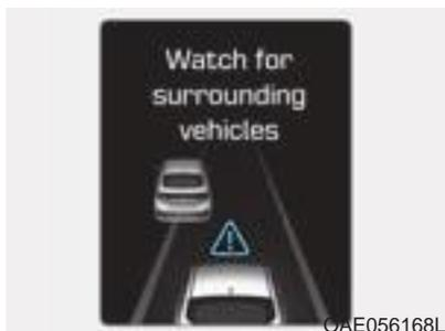
Se il veicolo davanti (velocità del veicolo: inferiore a 30 km/h) si sposta nella corsia accanto, la spia acustica suonerà e comparirà il messaggio "Fare attenzione ai veicoli circostanti". Regolare la velocità del veicolo nell'eventualità che veicoli od oggetti possano apparire improvvisamente davanti a voi, premendo il pedale freno. Prestare sempre attenzione alla condizione della strada davanti.
