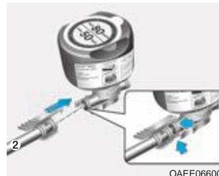
2. Avvitare il tubo flessibile di riempimento (2) sul connettore della bomboletta del mastice.
