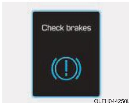
Questo messaggio spia viene visualizzato quando la funzionalità del freno è bassa o la frenata rigenerativa non funziona a dovere a causa di un guasto nel sistema freno.
