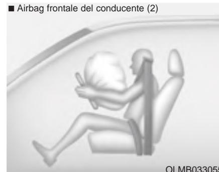
Al momento del dispiegamento, le giunture a strappo praticate direttamente nei rivestimenti delle imbottiture si staccheranno sotto la pressione prodotta dall'espansione degli airbag. L'ulteriore apertura dei rivestimenti consente il completo gonfiamento degli airbag.
