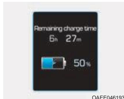
12. Una volta che la carica si è avviata, il tempo di carica stimato viene visualizzato sul quadro strumenti per circa 1 minuto.
