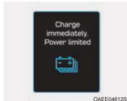
Quando il livello della batteria ad alta tensione si abbassa sotto al 5%, viene visualizzato questo messaggio.
