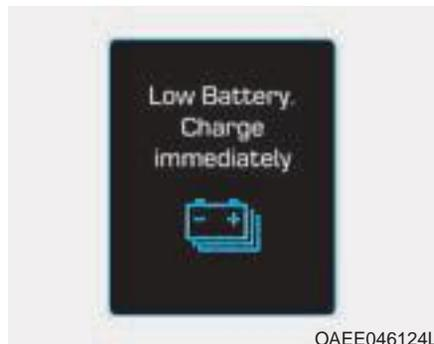
Quando il livello della batteria ad alta tensione si abbassa sotto al 4%, viene visualizzato questo messaggio.
