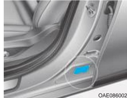
L'etichetta di omologazione del veicolo attaccata sul montante centrale lato conducente (o lato passeggero anteriore) riporta il numero d'identificazione veicolo (VIN).
