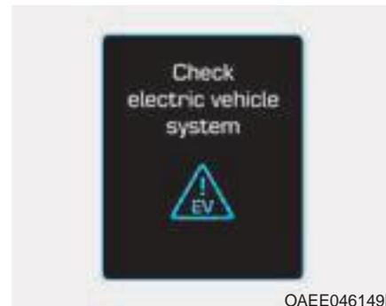
Questo messaggio spia viene visualizzato quando c'è un problema nel sistema di controllo veicolo elettrico.
