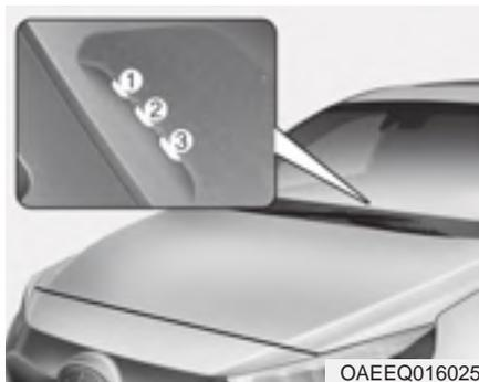
Quando si carica la batteria ad alta tensione, il livello di carica può essere controllato dall'esterno del veicolo.
