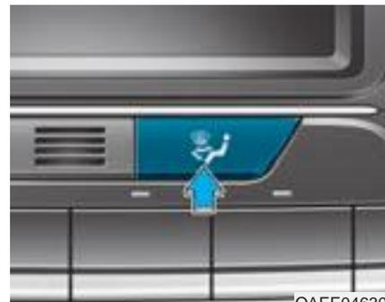
Il pulsante di selezione modo comanda la direzione del flusso di aria attraverso il sistema di ventilazione.
