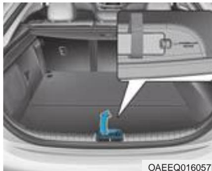
Se il connettore di carica non si scollega perché la batteria si è scaricata o a causa di un guasto ai conduttori elettrici, aprire il portellone e tirare leggermente il cavo di emergenza.
