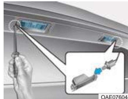
1. Usando un cacciavite a lama, fare leva delicatamente sul coperchio del trasparente dall'alloggiamento luce.
