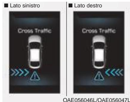
Se il veicolo rilevato dai sensori si avvicina al vostro veicolo, la spia acustica suonerà, la spia luminosa sullo specchietto retrovisore esterno lampeggerà e comparirà un messaggio sul display LCD.
