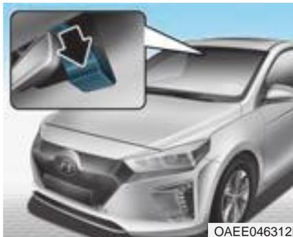
Il disappannamento automatico riduce la possibilità di appannamento dell'interno del parabrezza rilevando automaticamente il tasso di umidità sull'interno del parabrezza.
