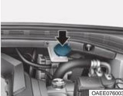
Controllare il livello del fluido freno nel serbatoio periodicamente. Il livello del fluido deve trovarsi tra le indicazioni MAX e MIN riportate sul lato del serbatoio.
