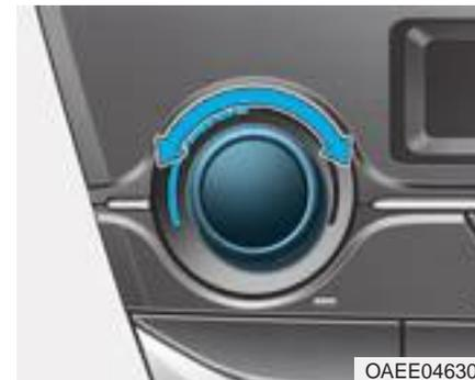
Ruotare la manopola di comando temperatura per impostare la temperatura desiderata.
