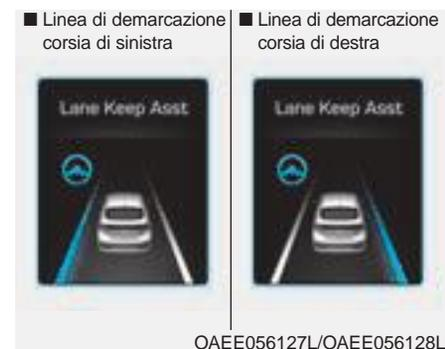
Sul display LCD del quadro strumenti compare una spia ottica. Sul display LCD del quadro strumenti lampeggerà la linea di demarcazione corsia di sinistra o la linea di demarcazione corsia di destra, a seconda della direzione verso la quale sta deviando il veicolo.
