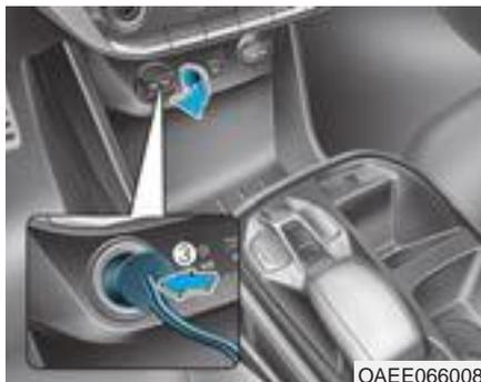
7. Inserire il cavo connettore di alimentazione compressore (3) nella presa di alimentazione del veicolo.
