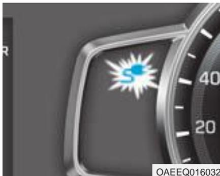
11. Controllare se l'indicatore luminoso carica della batteria ad alta tensione nel quadro strumenti si è acceso. La carica non viene eseguita se l'indicatore luminoso carica è spento.
