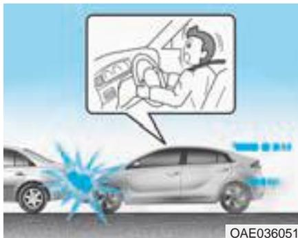
In determinate collisioni a bassa velocità, gli airbag potrebbero non dispiegarsi. Gli airbag sono progettati per non dispiegarsi nei suddetti casi in quanto non garantirebbero alcun beneficio maggiore rispetto alla protezione fornita dalle cinture di sicurezza.
