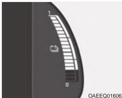
L'indicatore SOC mostra lo stato di carica della batteria ad alta tensione. La posizione "L (Bassa) o 0" sull'indicatore indica che non c'è abbastanza energia nella batteria ad alta tensione. La posizione "H (Alta) o 1" indica che la batteria di guida è completamente carica.
