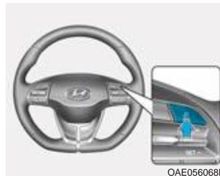
Per prima cosa, commutare sul modo Cruise Control premendo il pulsante
