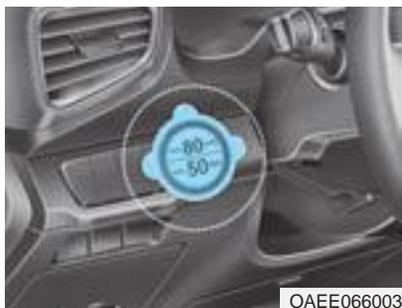
Staccare l'etichetta limite di velocità (0) dalla bomboletta del mastice (1), e sistemarla in un posto ove risulti ben visibile all'interno del veicolo, per esempio sul volante, per ricordare al conducente di tenere una velocità moderata.
