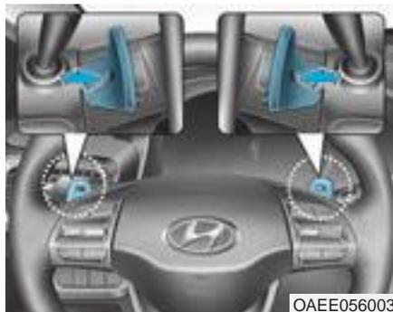
Il selettore a joystick è usato per regolare il tasso di frenata rigenerativa da 0 a 3 in fase di decelerazione o frenata.
