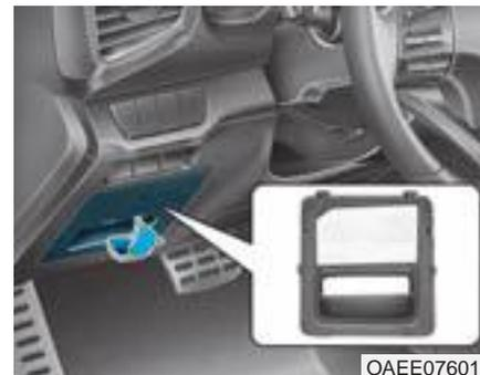
All'interno del coperchio scatola fusibili/relè si trova l'etichetta dei fusibili/relè indicante nome e capacità di ogni fusibile/relè.
