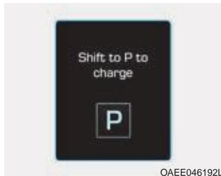
Questo messaggio viene visualizzato se si collega il cavo di carica senza portare il cambio in P (Parcheggio). Portare il cambio in P (Parcheggio) prima di collegare il cavo di carica.
