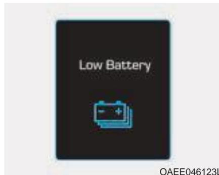
Quando il livello della batteria ad alta tensione si abbassa sotto al 13%, viene visualizzato questo messaggio. La spia luminosa sul quadro strumenti (🔋) si accenderà contemporaneamente.
