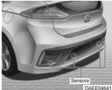
Il sistema di assistenza parcheggio in retromarcia aiuta il conducente nella movimentazione del veicolo in retromarcia suonando ogni qualvolta rileva la presenza di un oggetto qualsiasi entro una distanza di 120 cm dietro il veicolo.
