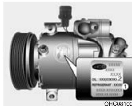
L'etichetta del compressore riporta le informazioni inerenti il tipo di compressore in dotazione al vostro veicolo come il modello, in numero categorico assegnato dal fornitore, il numero di produzione, il refrigerante (1) e l'olio per refrigerante (2).
