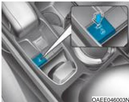
Quando il veicolo è in funzione, premere il pulsante volante riscaldato per scaldare il volante. L'indicatore sul pulsante s'illuminerà. Per disattivare il volante riscaldato, premere di nuovo il pulsante. L'indicatore sul pulsante si spegnerà.
