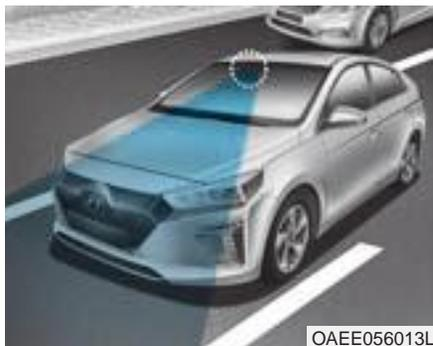
Il sistema di assistenza mantenimento corsia aiuta a rilevare le linee di demarcazione corsia sulla strada per mezzo di una telecamera situata sul parabrezza e assiste il conducente nell'uso dello sterzo per far sì che il veicolo rimanga all'interno della corsia.
