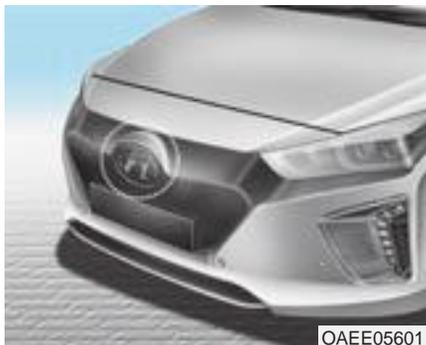
Il Cruise Control intelligente usa un sensore per rilevare la distanza dal veicolo davanti.
