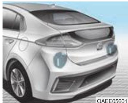
I sensori sono ubicati all'interno del paraurti posteriore. Tenere sempre il paraurti posteriore pulito perché il sistema operi a dovere.
