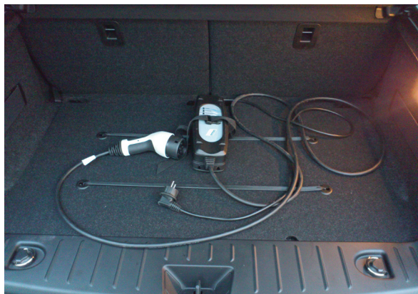
Di serie, nel bagagliaio della i3 è previsto un cavo di ricarica con relativo trasformatore per la connessione alle prese domestiche: per la ricarica rapida occorre un cavo specifico, fornito come optional
