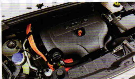
Il sistema ibrido HDI Peugeot è composto da un classico 2 litri turbodiesel da 163 CV, che tira dalle ruote anteriori, e da un motore elettrico sincrono a magneti permanenti, che agisce sull'asse posteriore.
