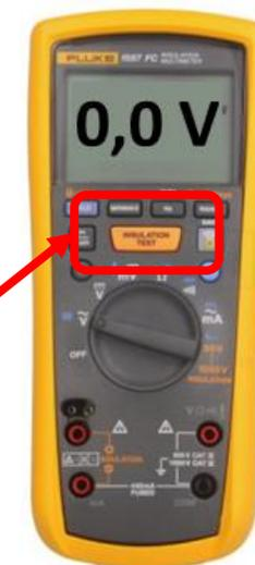
Per le misure previste per la messa in sicurezza va utilizzato il multimetro ad alta tensione con funzione «TEST ISOLAMENTO»
