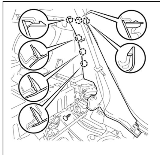
20. REMOVE HYBRID VEHICLE BATTERY SHIELD SHEET
