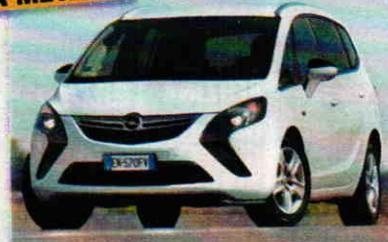
Associato al brillante quattro cilindri 1.6 turbo a benzina da 150 CV a 5000 giri, è un sistema bi-fuel prodotto dalla Opel. Per fare spazio alle bombole (sotto il pianale) che contengono 25 kg di gas, è stato ridotto al minimo il serbatoio della benzina, che contiene solo 14 litri: per questo la EcoM viene considerata "monocarburante" e paga il 75% in meno di bollo.
