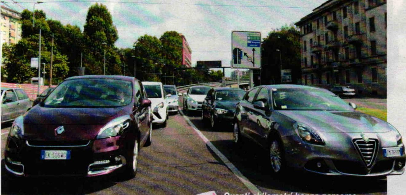
La fama di efficienza delle vetture ibride in città è assolutamente meritata. Oltre a essere in grado di percorrere brevi tratti a "zero emissioni", con l'ausilio del motore elettrico sfruttano al meglio ogni goccia di carburante, garantendo percorrenze anche doppie rispetto a quelle delle vetture a gas, più del 70% di vantaggio su quella a benzina e del 30-35% sulla turbodiesel.
