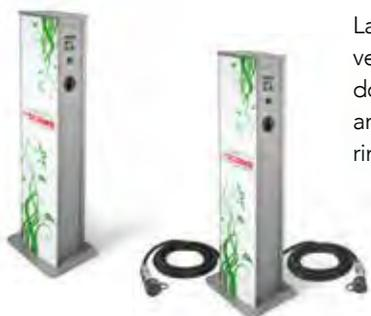
La colonnina CA è una stazione di ricarica bifacciale a basamento realizzata in lamiera d'acciaio verniciata equipaggiabile con prese da incasso con blocco antiestrazione e sistema antivandalismo domestico e prese mobili con cavo permanentemente connesso. Indicate per installazione in aree aperte private o pubbliche e caratterizzate dalla presenza di pannelli frontali in plexiglass rimovibili che consentono una facile e veloce personalizzazione.
