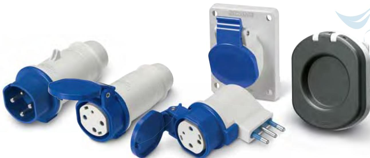
Il connettore tipo 3A nasce in Italia nel 2000 come unico sistema di connessione per la ricarica dei veicoli elettrici in ambienti aperti a terzi in modo 3. Caratterizzato da una costruzione derivata dalle spine Scame IEC309, dalle quali ha ereditato il dispositivo di chiusura rapido snap-on, si distingue per la presenza di un contatto aggiuntivo CP per la realizzazione del circuito pilota per la verifica
