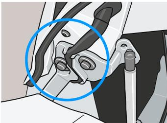
Die Flügeltüren sind mit Trennbolzen befestigt.
