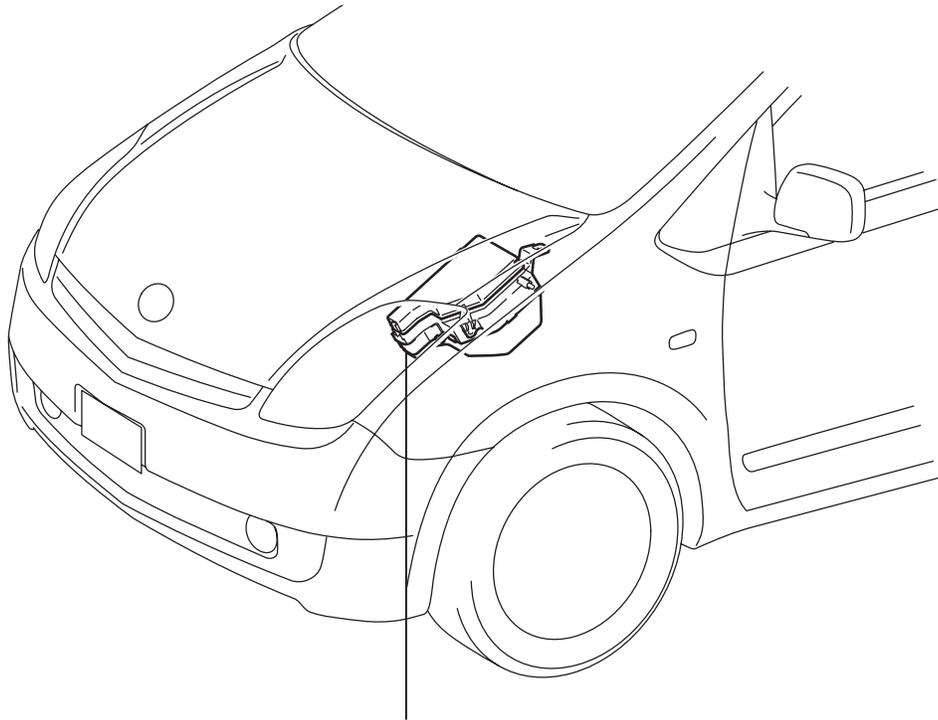
ENGINE ROOM JUNCTION BLOCK, RELAY BLOCK
