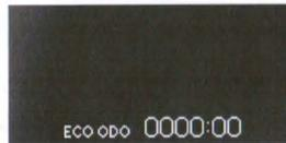
Visualizza il tempo totale per il quale il motore è stato spento a causa del funzionamento del sistema di spegnimento & avviamento intelligente dall'ultimo azzeramento del sistema.
