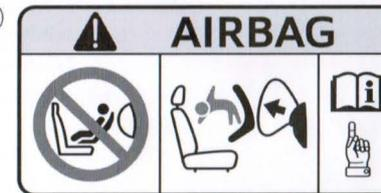
Non usare mai un sistema di ritenuta per bambini rivolto in senso opposto alla direzione di marcia sul sedile del passeggero anteriore quando l'interruttore di attivazione/disattivazione manuale airbag è attivato. (→P. 58)
