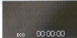
Visualizza il tempo per il quale è stato spento il motore a causa del funzionamento del sistema di spegnimento & avviamento intelligente durante il viaggio attuale (dal momento in cui è stato avviato il motore finché non viene spento).
