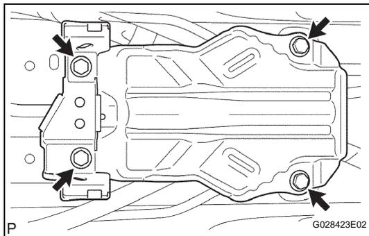
**5. INSTALL NO. 1 CONSOLE BOX MOUNTING BRACKET**
