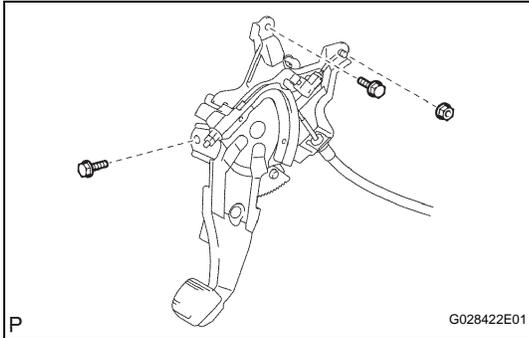
4. **INSTALL PARKING BRAKE CONTROL PEDAL ASSEMBLY**
