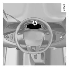
**Quadro della strumentazione A**: si illumina all'inserimento del contatto.
