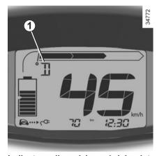
Indicatore di posizione 1 del selettore di velocità (N, D o R).
