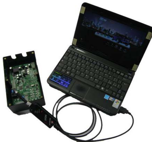
Fig. 6.3 – Programmatore PICKit 2 collegata al Pc assistenza e alla periferica da programmare (Centralina BMS nella foto).
