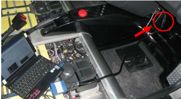
Fig. 5.2 – PC assistenza connesso all'Adattatore CAN to USB ed alla presa di diagnostica BMS.
