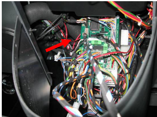
Fig. 9.4 – Scheda interfaccia montata sul veicolo.
