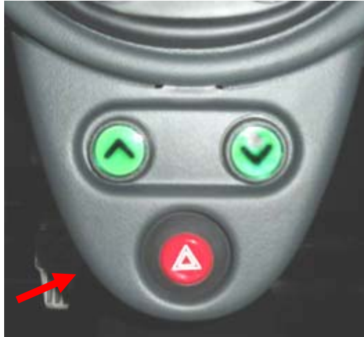
Fig. 9.3 – Cover di plastica che supporta i pulsanti direzione e hazard.
