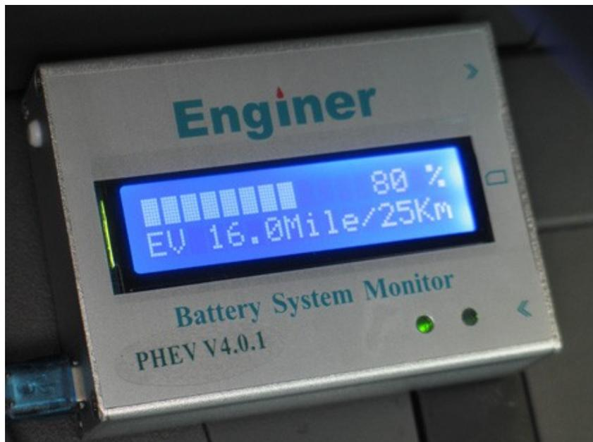
Pagina 1: mostra il SOC (State Of Charge = Livello di carica) delle batterie ai polimeri di Litio e una stima della strada percorribile in modalità EV (Electric Vehicle)
