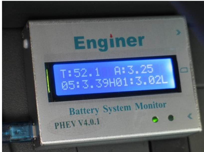
Pagina 4: mostra il voltaggio totale (T), il voltaggio medio (A), la cella con il voltaggio più elevato (H) e quella con il voltaggio più basso (L).
