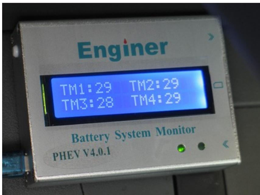
Pagina 3: mostra la temperatura delle batterie. TM1 e TM2 si riferiscono alla temperatura delle celle 1-4 e 5-8 del pacco batterie RIGHT; TM3 e TM4 si riferiscono alla temperatura delle celle 9-12 e 13-16 del pacco batterie LEFT.
