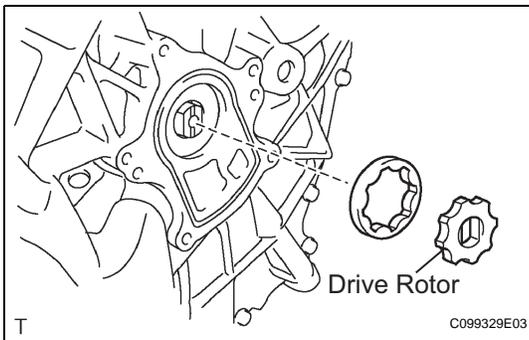
**3. INSTALL TRANSAXLE OIL PUMP DRIVE ROTOR**
