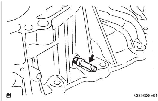
**29. REMOVE TRANSAXLE HOUSING TUBE CONNECTOR**
