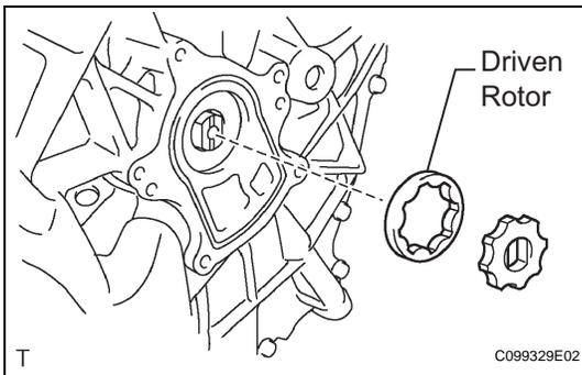
**2. INSTALL OIL PUMP DRIVEN ROTOR**
