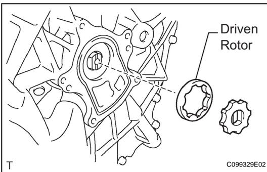
6. REMOVE OIL PUMP DRIVEN ROTOR
