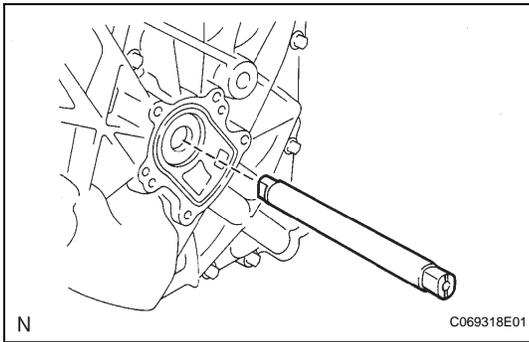
**7. REMOVE OIL PUMP DRIVE SHAFT**
