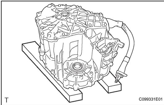
**4. INSTALL HYBRID TRANSAXLE TYPE T OIL SEAL LH**
