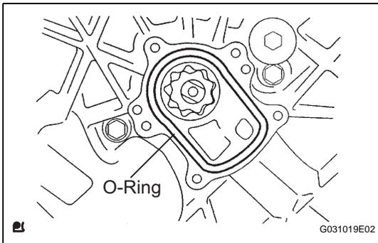
**25. INSTALL TRANSMISSION OIL PUMP COVER SUB-ASSEMBLY**
