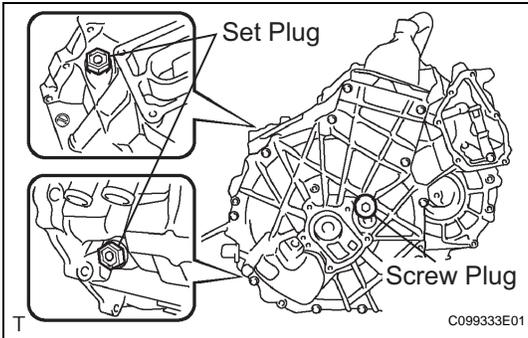
**24. REMOVE TRANSAXLE HOUSING AND CASE WITH HEAD STRAIGHT SCREW PLUG**
