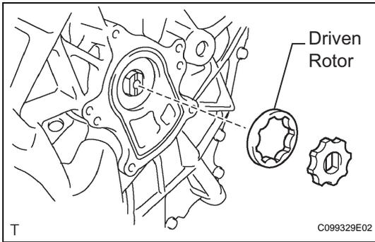
**23. INSTALL OIL PUMP DRIVEN ROTOR**
