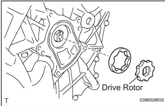
**24. INSTALL TRANSAXLE OIL PUMP DRIVE ROTOR**
