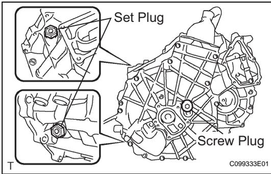
**2. INSTALL TRANSAXLE HOUSING AND CASE WITH HEAD STRAIGHT SCREW PLUG**
