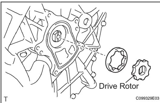
5. REMOVE TRANSMISSION OIL PUMP DRIVE ROTOR
