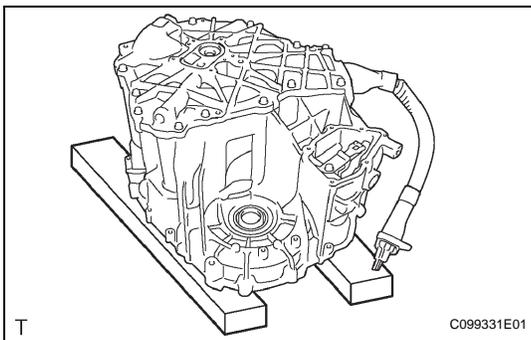
**23. REMOVE HYBRID TRANSAXLE OIL SEAL LH**
