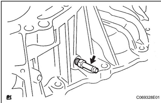
**18. INSTALL TRANSAXLE HOUSING TUBE CONNECTOR**
