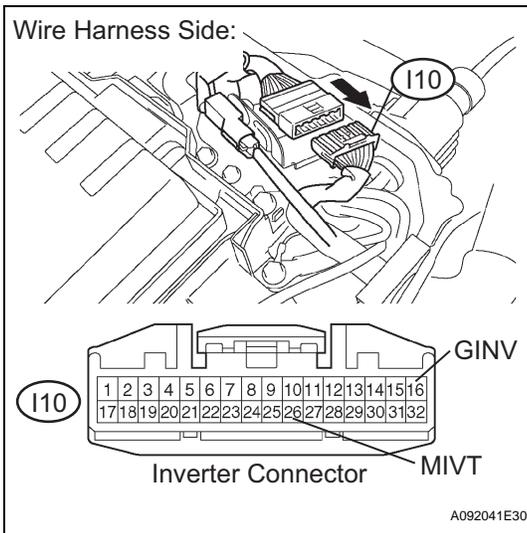
(d) Disconnect the I10 inverter connector.
