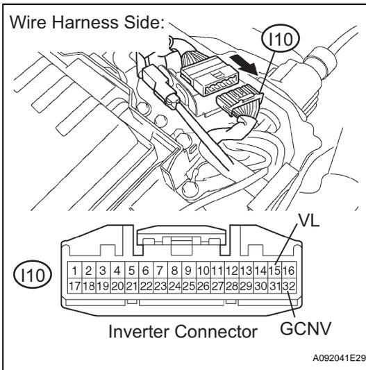
(d) Disconnect the I10 inverter connector.
