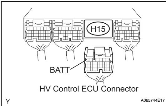
(d) Disconnect the H15 HV control ECU connector.
