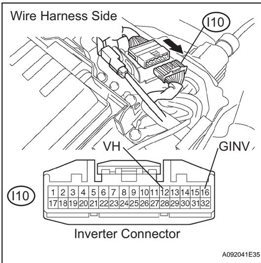
(d) Disconnect the I10 inverter connector.
