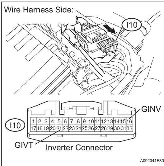
(d) Disconnect the I10 inverter connector.
