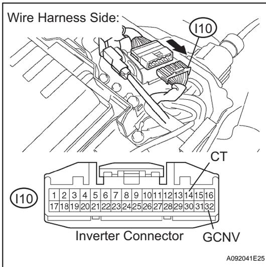
(d) Disconnect the I10 inverter connector.
