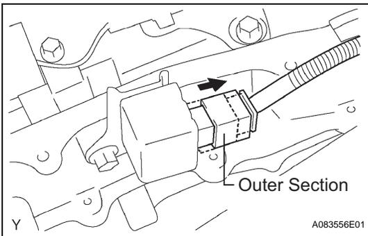
**24. DISCONNECT NO. 1 CIRCUIT BREAKER SENSOR**
