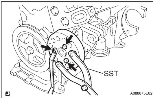
**9. REMOVE WATER PUMP PULLEY**
