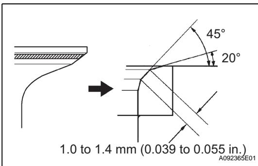
**10. REPAIR INTAKE VALVE SEAT**
