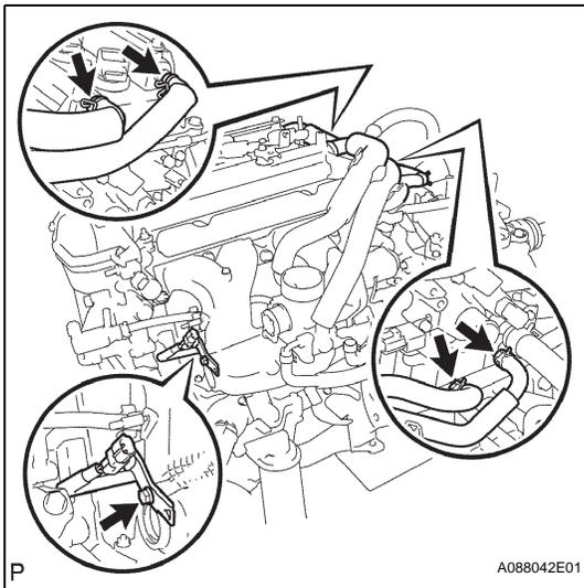
**53. REMOVE INTAKE MANIFOLD**
