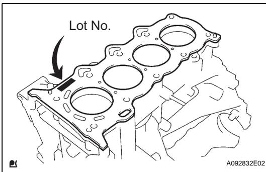
**18. INSTALL CYLINDER HEAD GASKET**
