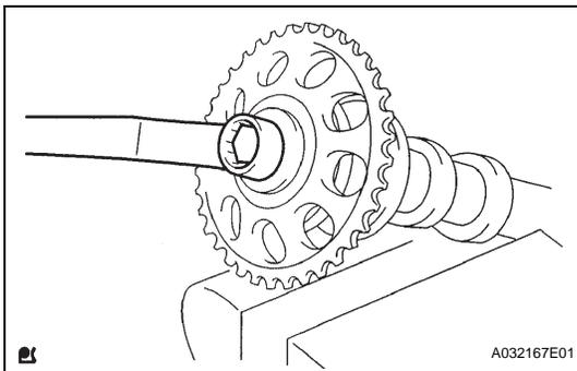
**22. INSTALL CAMSHAFT TIMING SPROCKET**
