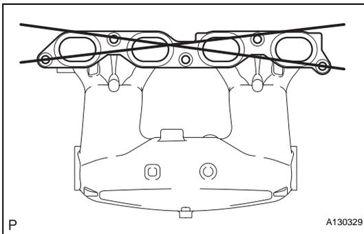
**INSPECTION****1. INSPECT INTAKE MANIFOLD**
