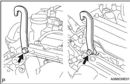
(d) Remove the bolts and engine hangers.
