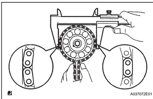
**16. INSPECT CAMSHAFT TIMING SPROCKET**
