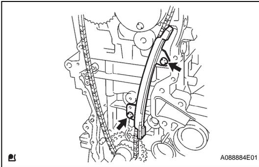
**19. REMOVE NO. 1 CHAIN VIBRATION DAMPER**
