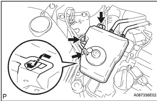
**17. INSTALL BRAKE MASTER CYLINDER RESERVOIR**
