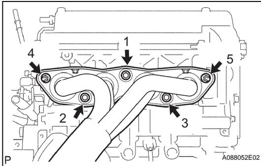
**3. INSTALL EXHAUST MANIFOLD**
