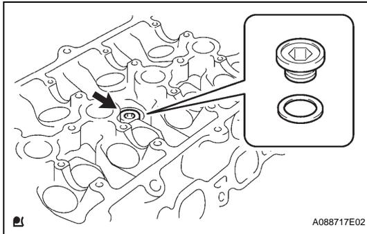
**8. INSTALL NO. 1 TAPER SCREW PLUG**
