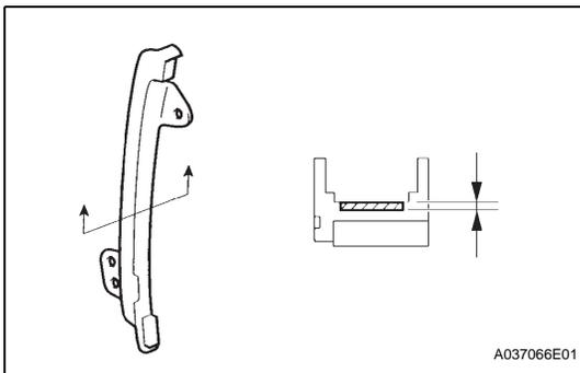
**4. INSPECT NO. 1 CHAIN VIBRATION DAMPER**
