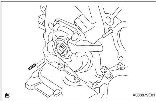
**27. INSTALL CRANKSHAFT PULLEY**
