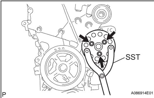
**37. INSTALL WATER PUMP PULLEY**
