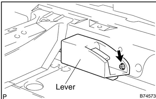
**2. REMOVE FUEL LID LOCK CONTROL CABLE SUB-ASSY**
