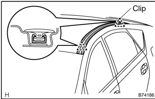
**3. INSTALL ROOF DRIP SIDE FINISH MOULDING**
