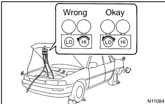
6. **DO NOT OPERATE COMPRESSOR WITHOUT ENOUGH REFRIGERANT IN REFRIGERANT SYSTEM**
