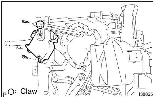
**24. AIR OUTLET CONTROL SERVOMETER**
