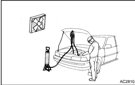
1. **DO NOT HANDLE REFRIGERANT IN AN ENCLOSED AREA OR NEAR AN OPEN FLAME**
