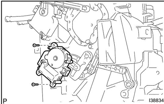
**23. REMOVE AIR MIX CONTROL SERVOMETER**
