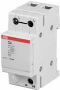
Gli scaricatori di sovratensioni di Tipo 1 forniscono protezione all'ingresso per installazioni in zone ad alta frequenza di fulminazione e sono tipicamente installati nei quadri di distribuzione primaria per proteggere dalla fulminazione diretta.
