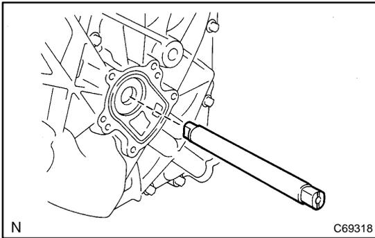
**8. INSTALL OIL PUMP DRIVE SHAFT**
