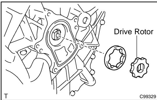
**10. INSTALL TRANSAXLE OIL PUMP DRIVE ROTOR**
