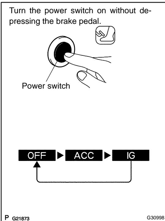
(d) Turn the power switch on once without depressing the brake pedal.
