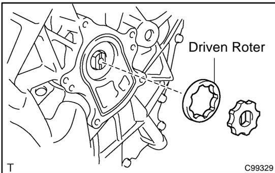
**9. INSTALL OIL PUMP DRIVEN ROTOR**
