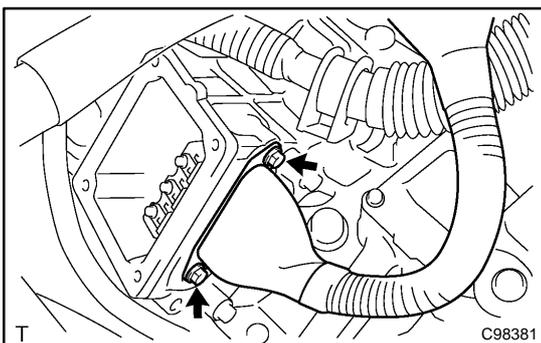
(d) Install the generator cable with the 2 bolts.
