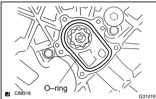
**59. INSTALL TRANSMISSION OIL PUMP COVER SUB-ASSY**
