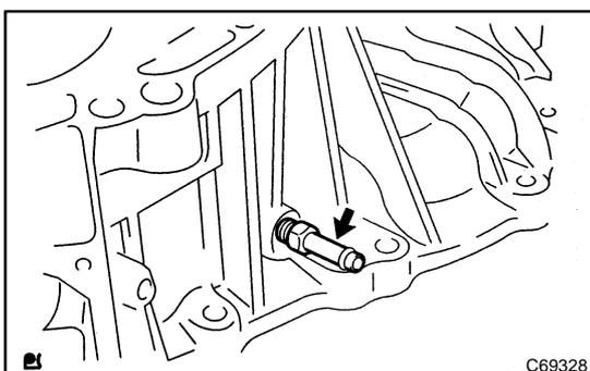
**52. INSTALL TRANSAXLE HOUSING TUBE CONNECTOR**
