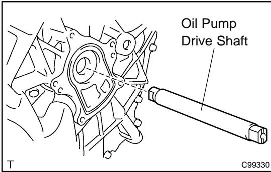
**56. INSTALL OIL PUMP DRIVE SHAFT**
