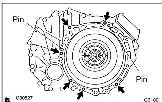
**28. INSTALL HYBRID VEHICLE TRANSAXLE ASSY**
