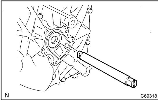
**7. REMOVE OIL PUMP DRIVE SHAFT**
