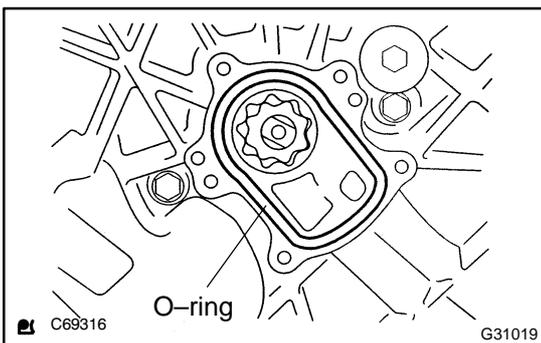
**11. INSTALL TRANSMISSION OIL PUMP COVER SUB-ASSY**
