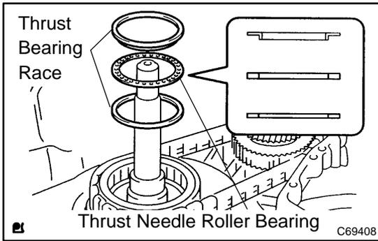
**5. REMOVE TRANSMISSION DRIVE SPROCKET SUB-ASSY**
