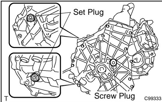
**24. REMOVE TRANSAXLE HOUSING & CASE W/HEAD STRAIGHT SCREW PLUG**
