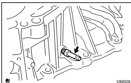
**29. REMOVE TRANSAXLE HOUSING TUBE CONNECTOR**
