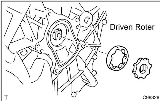
**57. INSTALL OIL PUMP DRIVEN ROTOR**
