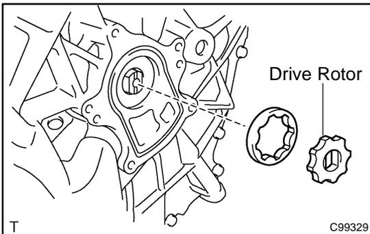
**58. INSTALL TRANSAXLE OIL PUMP DRIVE ROTOR**
