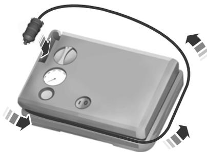
5. Avvolgere il cavo di alimentazione attorno all'alloggiamento e riporre la presa di alimentazione accessoria.
