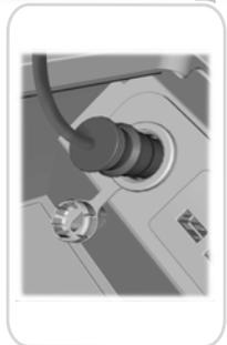
4. Collegare il cavo di alimentazione alla presa di alimentazione da 12 V nel veicolo.
