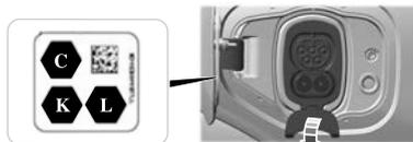
4. Inserire l'accoppiatore di carica nel terminale della porta di carica sul veicolo.
