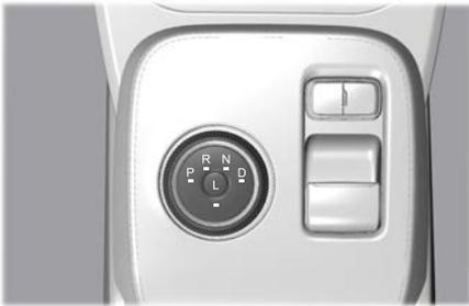
Il veicolo è dotato di un selettore marce elettronico. Il selettore del cambio si trova nella console centrale. Le marce vengono selezionate ruotando il selettore su **PRNDL**.
