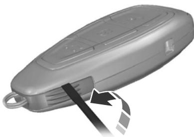
3. Ruotare il cacciavite nella posizione indicata per separare le due metà del telecomando.
