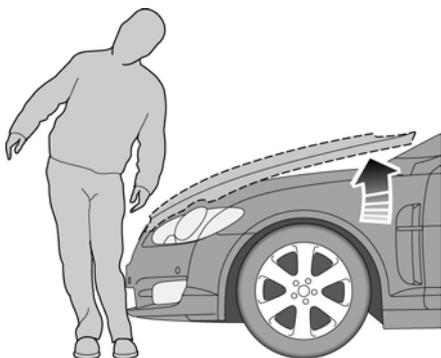
Il cofano attivo sblocca le cerniere del cofano e solleva l'estremità posteriore del cofano di circa 10 cm. In questo modo aumenta la distanza tra il cofano e i componenti all'interno del vano anteriore. Questo sistema ammortizza ulteriormente l'urto in caso di impatto tra pedone e cofano.
