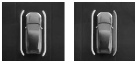
Se si attiva il sistema di mantenimento corsia, sul display informazioni compare una grafica con le linee di demarcazione delle corsie.
