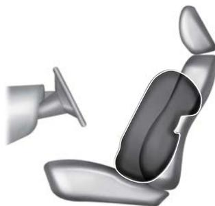
Questi airbag sono progettati per gonfiarsi tra il pannello portiera e l'occupante del veicolo al fine di aumentare la protezione in determinati tipi di incidente.
