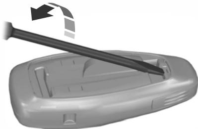
2. Utilizzare un cacciavite per separare con attenzione le due metà del telecomando.
