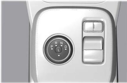
Il veicolo è dotato di un selettore marce elettronico. Il selettore del cambio si trova nella console centrale. Le marce vengono selezionate ruotando il selettore su
