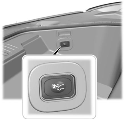
Se si è rimasti chiusi nel bagagliaio anteriore, è possibile uscirne premendo il pulsante di sblocco interno. Il materiale attorno all'interruttore riluce dopo una breve esposizione alle luci soffuse.
