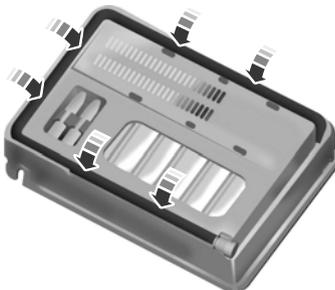
4. Avvolgere il flessibile bivalente (nero) nell'apposita canalina nella parte inferiore dell'alloggiamento.
