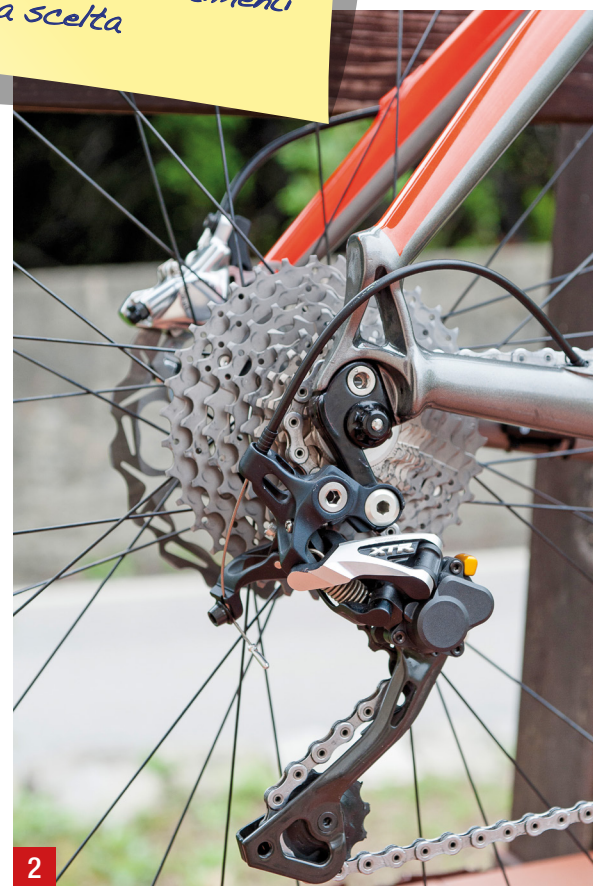
2 Il deragliatore posteriore della Terra fa parte del gruppo XTR di Shimano, mentre la cassetta pignoni è stata affidata all'azienda italiana PMP
