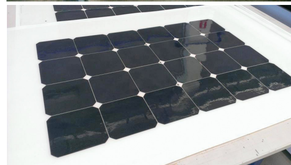
Le celle sono state racchiuse tra strati di materiali plastici: l'Ete e il Tpo
