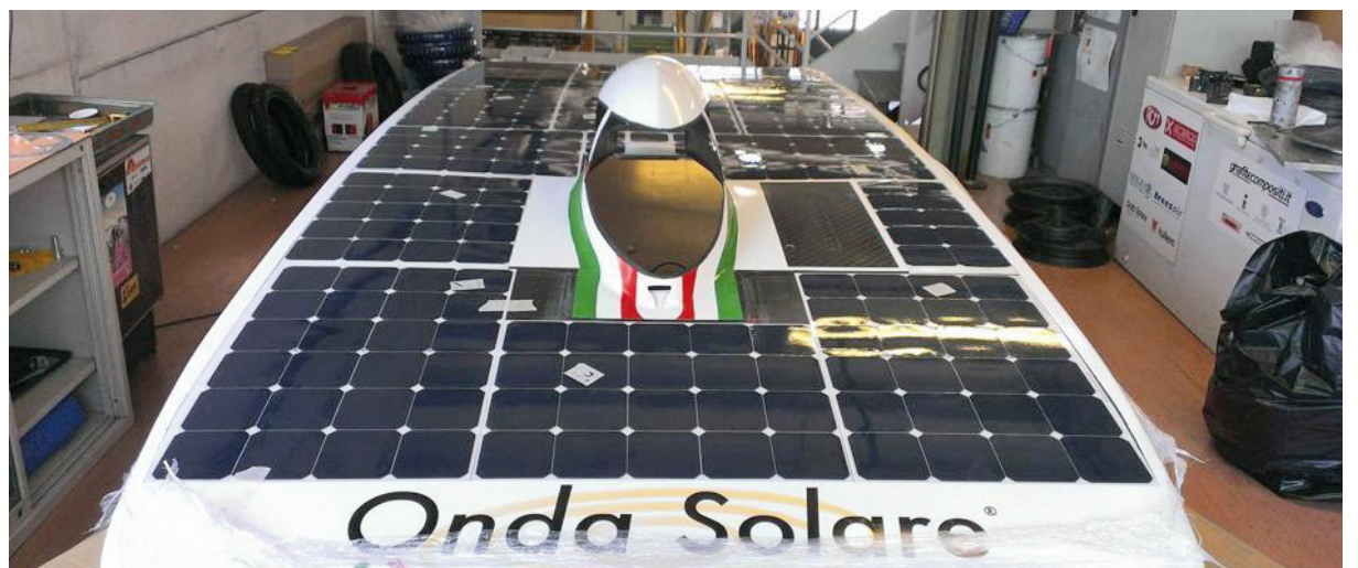
Emilia 3 è ricoperta da 391 celle solari Solbian in silicio monocristallino ad alta efficienza che garantiscono il 23% di efficienza e che forniscono 1,3 kW
