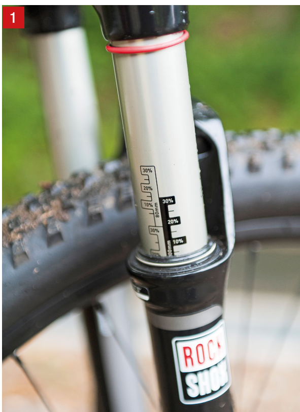
1 Un particolare della forcella Rock Shox Reba con escursione da 100 mm e bloccaggio lockout al manubrio 3 Sul lato destro del manubrio, in prossimità della manopola, troviamo il sistema Lockout che comanda la doppia regolazione della forcella anteriore
