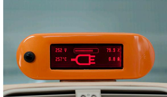
Il pannello d'informazione sul cruscotto con indicato il consumo istantaneo, lo stato di carica e l'autonomia residua. Cambiando schermata, appare la temperatura del pacco batterie. A vettura in fase di ricarica, si visualizzano il tempo rimanente per la ricarica completa e la percentuale di carica al momento
