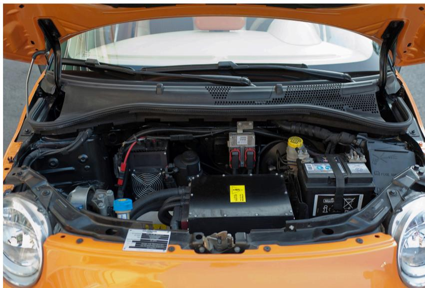
**Tutti i sistemi elettronici di comando e gestione del motore e del pacco batterie, così come l'inverter, sono collocati davanti: restano facilmente raggiungibili e bilanciano, almeno parzialmente, il peso del pacco batterie montato sull'assale posteriore**
