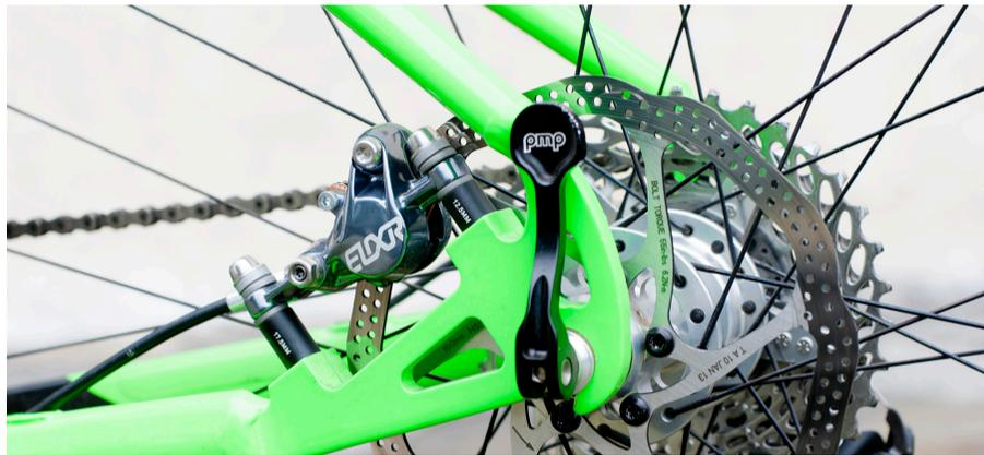
Gli sganci, come i mozzi delle ruote, sono di produzione italiana PMP mentre per l'impianto frenante sono stati scelti freni a disco Avid Elixir, sia sull'anteriore che sul posteriore
