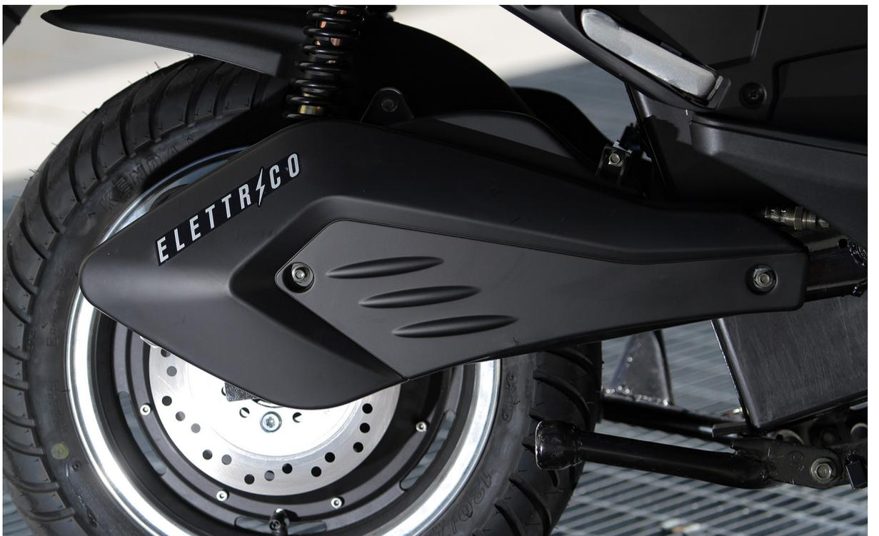
**Il cerchio ruota posteriore che ospita il motore elettrico da 1800W**
