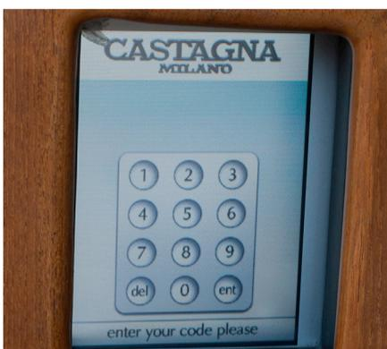
Lo schermo "touch" posto nel longherone sinistro. È il cuore del sistema di controllo della vettura, protetto da password numerica. Comanda l'accensione e lo spegnimento della Tender Two, fornisce le informazioni sullo stato della vettura e permette di attivare e disattivare i vari accessori montati
