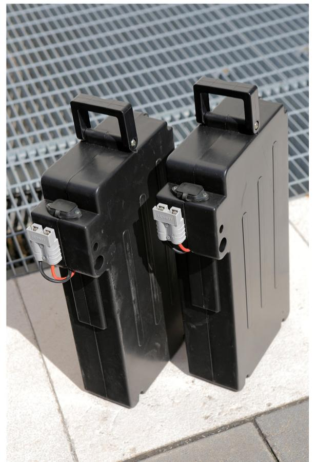
Il pacco batterie è facilmente estraibile per agevolare la carica anche a chi non dispone di un box o di un garage con presa elettrica
