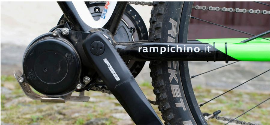
Il motore elettrico Sunstar S03+ da 250W è montato nella parte bassa del telaio, in prossimità della scatola del movimento centrale, per favorire la distribuzione dei pesi e il trasferimento di potenza durante la pedalata
