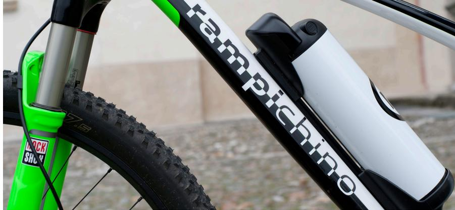
La batteria a borraccia agli ioni di litio da 286 Wh è posizionata centralmente lungo il tubo obliquo del telaio in alluminio
