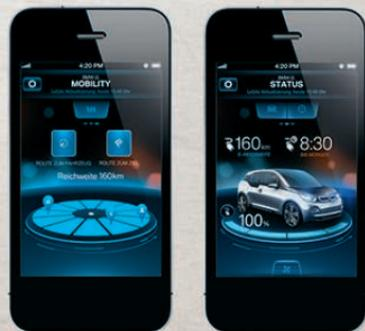
Con la «BMW i Remote App per Smartphone»<sup>1</sup> è possibile conoscere, ad esempio, l'autonomia della BMW i3 e l'effettivo livello di carica della batteria. Inoltre la batteria può essere preconditionata per ottenere un'autonomia maggiore.
