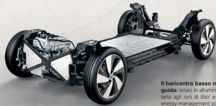
**Il baricentro basso migliora la dinamica di guida:** telaio in alluminio, motore elettrico, batteria agli ioni di litio<sup>1</sup> e l'intelligente sistema di energy management sono alla base del modulo Drive. Permettono di abbassare il baricentro e aumentano l'eccezionale agilità di guida e sicurezza della nuova BMW i3.
