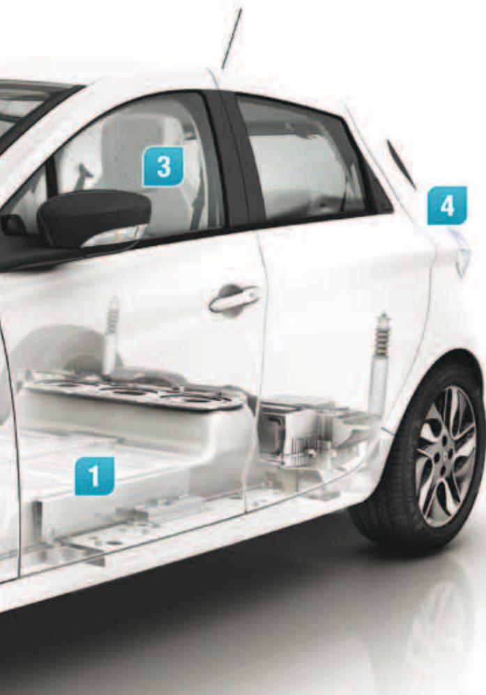
1. Batteria posta sotto il pianale per ottimizzare l'abitabilità ed il volume del bagagliaio. 2. Solo 1/3 della superficie è vetrata per uno stile ed un'autonomia migliori. 3. 5 posti. 4. Volume del bagagliaio di 338 L. 5. Recupero dell'energia in frenata di nuova generazione. 6. Pneumatici Michelin ENERGY® E-V. 7. Pompa di calore. 8. Caricatore Caméléon®, 3 modalità di ricarica possibili con un unico caricatore.
