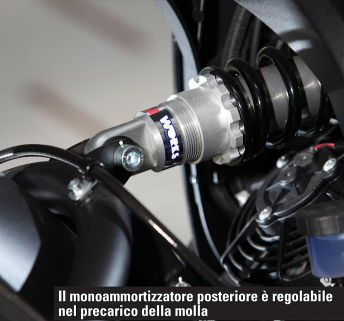
Il monoammortizzatore posteriore è regolabile nel precarico della molla
