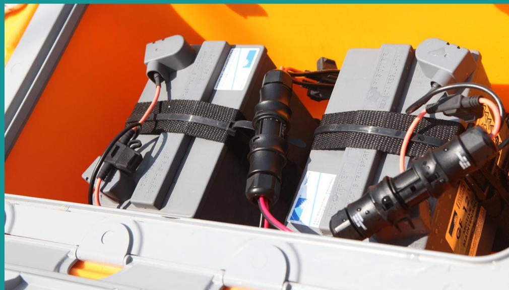
Il motore elettrico Brushless fornisce una potenza di 250 W, ed è alimentato da due batterie al piombo.
