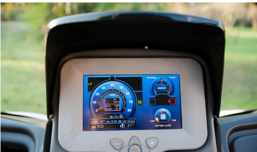
La strumentazione è tutta racchiusa nello schermo a LCD. Di serie comprende tutto quello che serve, con spie ed indicatori di funzionamento dei componenti principali e gli indicatori di stato delle batterie
