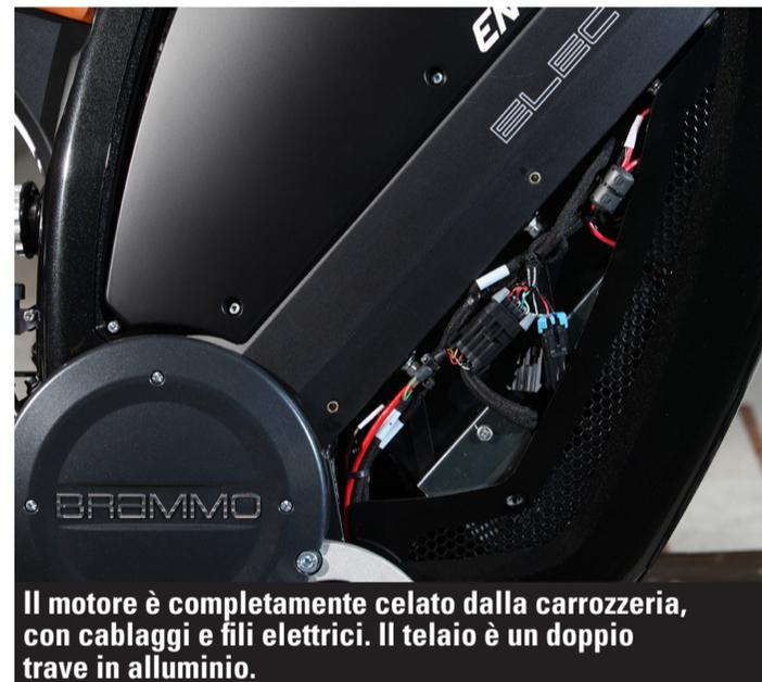
Il motore è completamente celato dalla carrozzeria, con cablaggi e fili elettrici. Il telaio è un doppio trave in alluminio.
