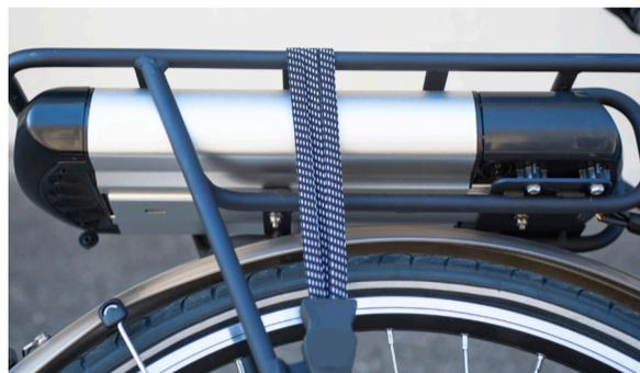
**Batteria SLIM da 37V, disponibile da 10Ah e da 12,5Ah. Estraibile, a scorrimento orizzontale, è posizionata sotto il portapacchi posteriore**
