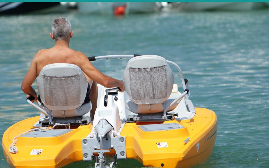
L'assistenza alla pedalata riprende il funzionamento di quella delle biciclette, con un intervento regolabile su quattro livelli.
