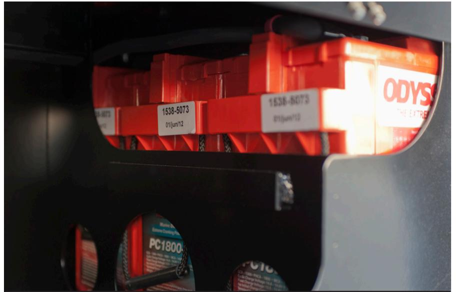
**Il pacco batterie con tecnologia piombo puro da 13 kWh. A richiesta si può avere il pacco batterie da 18 kWh piombo/acido (2690 Euro) oppure il doppio pacco al piombo puro, 26 kWh (4600 Euro)**
