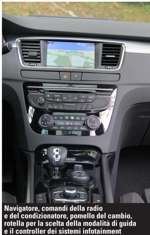
**Navigatore, comandi della radio e del condizionatore, pomello del cambio, rotella per la scelta della modalità di guida e il controller dei sistemi infotainment**
