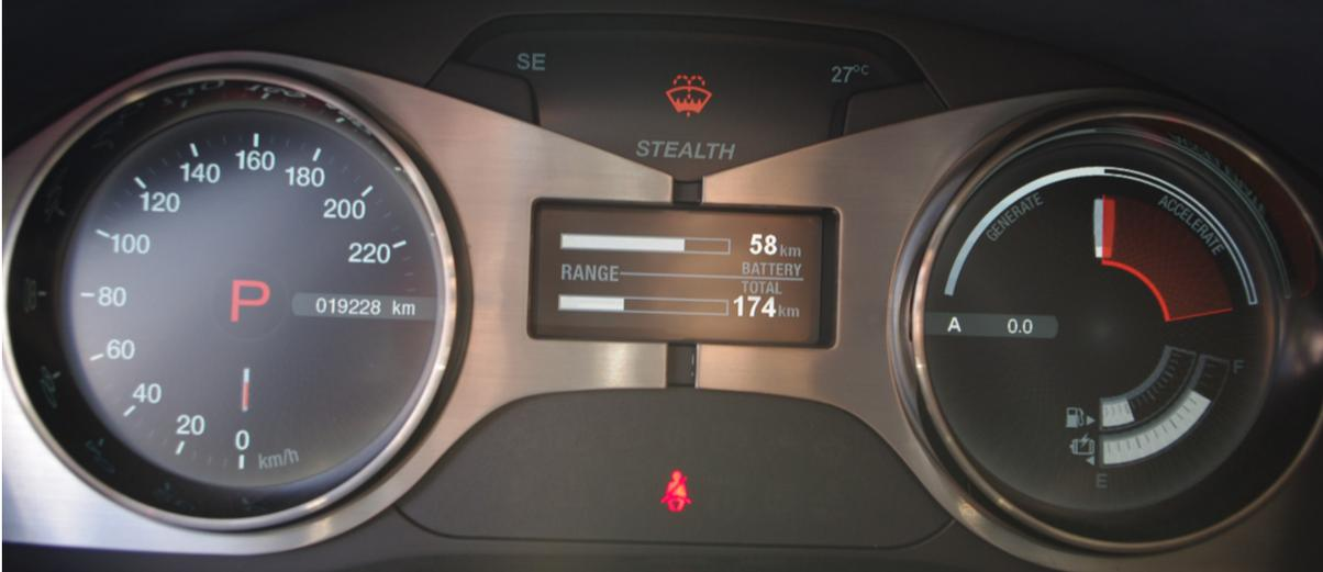
La strumentazione, con a sinistra contachilometri ed indicatore di marcia, a destra nella parte superiore, l'indicatore istantaneo di consumo/ricarica del pacco batterie, il consumo in Ampere ed in basso il livello del carburante e dell'energia residua. Al centro il display multifunzione, con visibile, in questo caso, l'autonomia residua con il carburante e l'energia disponibile
