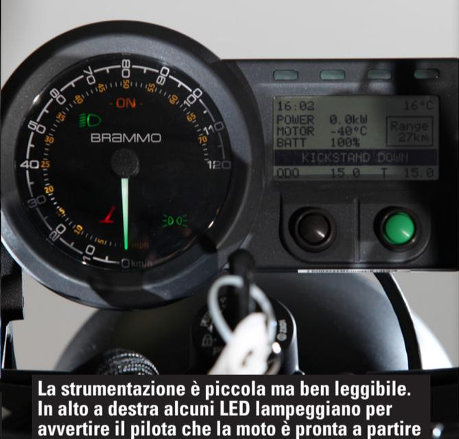
La strumentazione è piccola ma ben leggibile. In alto a destra alcuni LED lampeggiano per avvertire il pilota che la moto è pronta a partire
