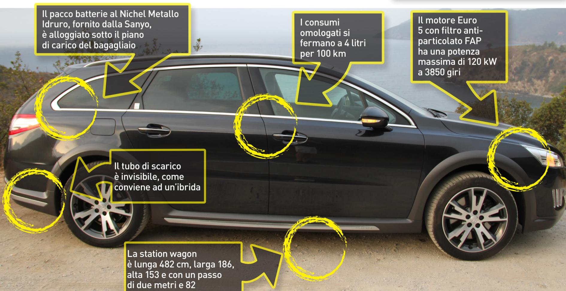
Il pacco batterie al Nichel Metallo Idruro, fornito dalla Sanyo, è alloggiato sotto il piano di carico del bagagliaio
