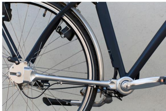
**Trasmissione a cardano. Elimina la manutenzione e la lubrificazione della catena preservando mani e vestiti dalle macchie di grasso**
