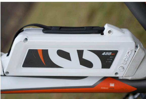
**Batteria Bosch posizionata sul tubo obliquo del telaio**
