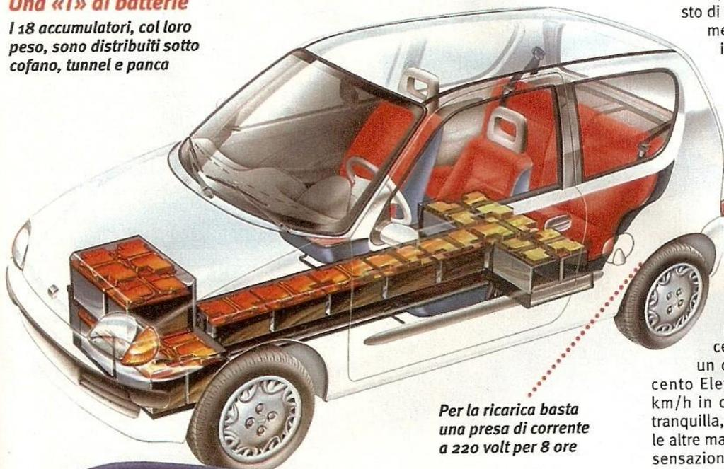
Per la ricarica basta una presa di corrente a 220 volt per 8 ore
