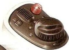
**Cambio facile: «D» per marcia con potenza di 15 kW, «S» per avere a disposizione tutti i 30 kW**
