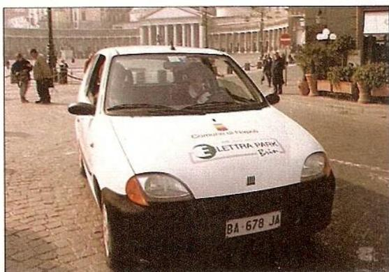
**Motore e trazione posteriori, niente cambio: ecco la prima vera «quattro posti» ecologica italiana, con un piccolo propulsore da 30 kW e 18 batterie. I risultati? Una guida facile e un'autonomia soddisfacente per la città: l'abbiamo provata sulle strade di Napoli.**
