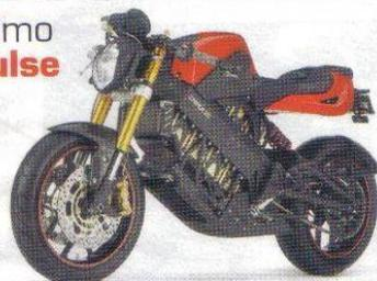
Per chi cerca "emozioni elettriche" c'è l'americana Brammo che produce tre vere moto sportive: Energia, Energia Plus ed Empulse. Quest'ultima, la più potente, ha un **motore da 40 kW con coppia di 80 Nm** e batterie al litio da 10 kWh, che consentono di raggiungere i 160 km/h e di percorrere 160 km. Si acquista su internet e costa fino a 13.995 dollari.
