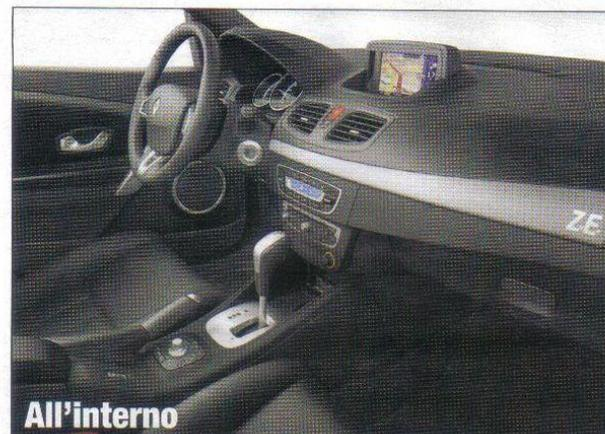
L'abitacolo ha un'impostazione tradizionale e anche la leva nel tunnel funziona in modo simile a quella di un cambio convenzionale, se non fosse che scegliendo la posizione "D" (Drive) si innesta un **rapporto di trasmissione fisso**. Il solo indizio che permette di capire che siamo a bordo di un'elettrica è il cruscotto: l'indicatore a sinistra del tachimetro mostra la carica residua della batteria, quello a destra la potenza impiegata oppure quella recuperata quando si rallenta o si frena.
