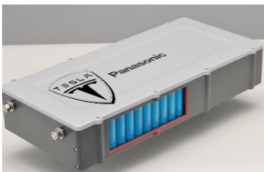
Sulle vetture BEV si adottano accumulatori di tipo Li-pol, (Panasonic per la Tesla) e Ni-NaCl (batterie ZEBRA per veicoli leggeri da lavoro, quali furgoni e bus)
