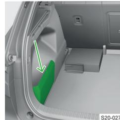
Il carico massimo dell'elemento Cargo è di 8 kg.
