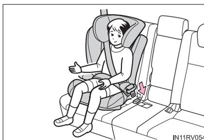
Verificare che la cintura diagonale sia correttamente posizionata sulla spalla del bambino e che la sezione trasversale della cintura sia posizionata nel punto più basso possibile. (→P. 34)
