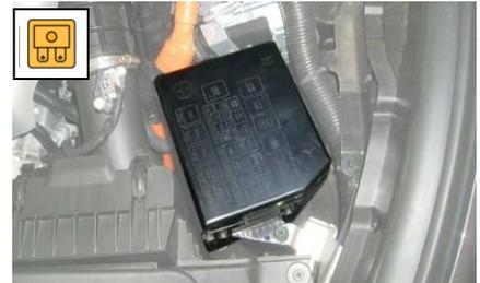
2. Dargestellte Sicherungen im Kastendeckel entfernen.
