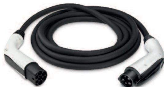
Il cord-set è il mezzo con il quale stazione e veicolo vengono collegati e si compone di una spina mobile per la connessione lato infrastruttura, una presa mobile per il lato veicolo, un cavo di adeguata sezione e polarità adatto all'uso mobile con particolare resistenza alle condizioni d'uso.
