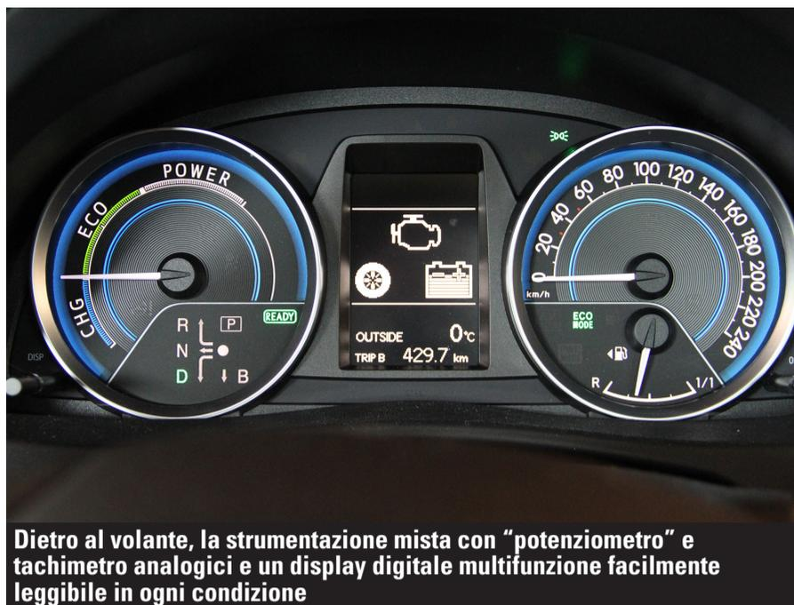
Dietro al volante, la strumentazione mista con "potenziometro" e tachimetro analogici e un display digitale multifunzione facilmente leggibile in ogni condizione
