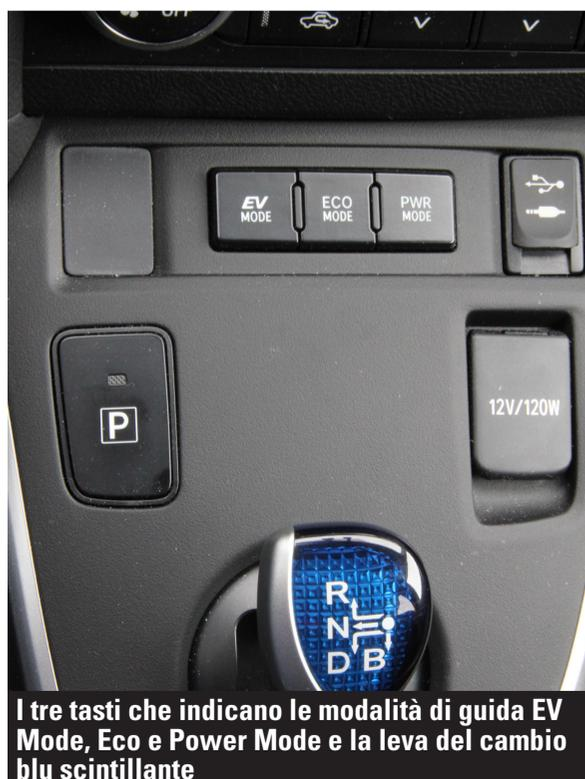
I tre tasti che indicano le modalità di guida EV Mode, Eco e Power Mode e la leva del cambio blu scintillante
