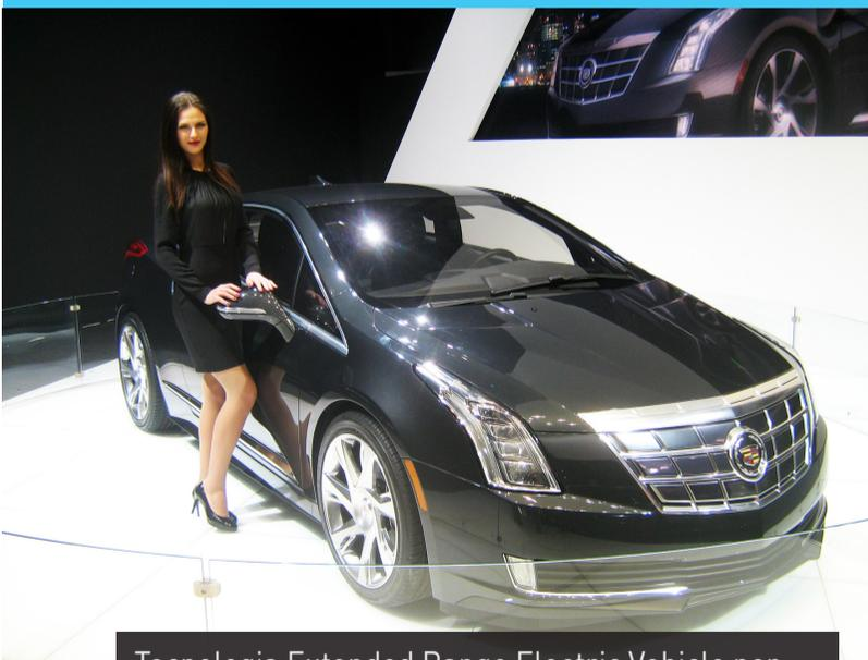
Tecnologia Extended Range Electric Vehicle per la **Cadillac ELR**, che unisce la guida in modalità puramente elettrica a un efficiente motore a benzina 1.4l, garantendo così una percorrenza di circa 480 km con una sola ricarica rispetto a un unico pieno
