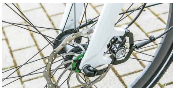
Freni a disco Magura Mt4 con rotore da 18 millimetri
