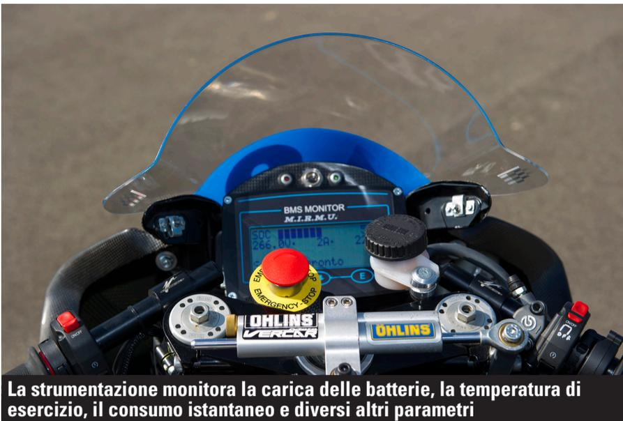
La strumentazione monitora la carica delle batterie, la temperatura di esercizio, il consumo istantaneo e diversi altri parametri
