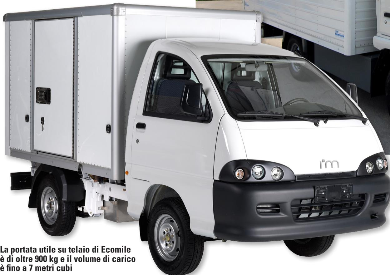
**La portata utile su telaio di Ecomile è di oltre 900 kg e il volume di carico è fino a 7 metri cubi**
