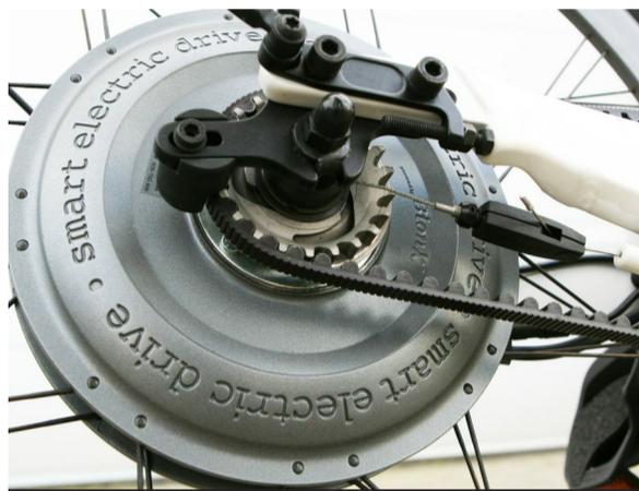
Il motore è tutto qui, nel mozzo. E quando si aziona il freno ricarica la batteria
