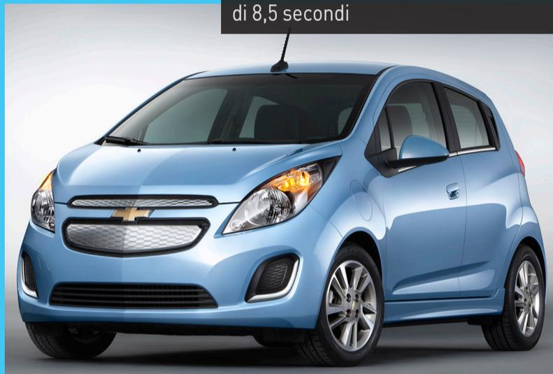
La **Chevrolet Spark Electric Vehicle (EV)**, presentata in anteprima europea, è equipaggiata con un motore elettrico a magneti permanenti da 100 kW di potenza e 542 Nm di coppia che permette di accelerare da 0 a 100 km/h in meno di 8,5 secondi
