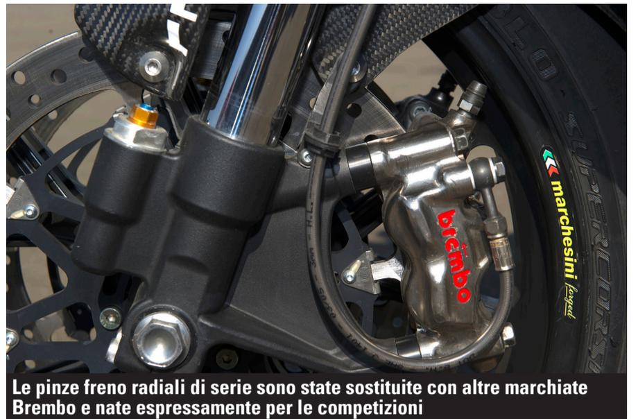
Le pinze freno radiali di serie sono state sostituite con altre marchiate Brembo e nate espressamente per le competizioni
