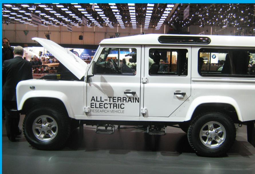
Nella **Land Rover Electric Defender**, il diesel e la trasmissione di serie sono stati sostituiti da un motore elettrico da 70 kW (94 cv) e 330 Nm, accoppiato a un accumulatore agli ioni di litio della capacità di 27 kWh, per un'autonomia di oltre 80 km
