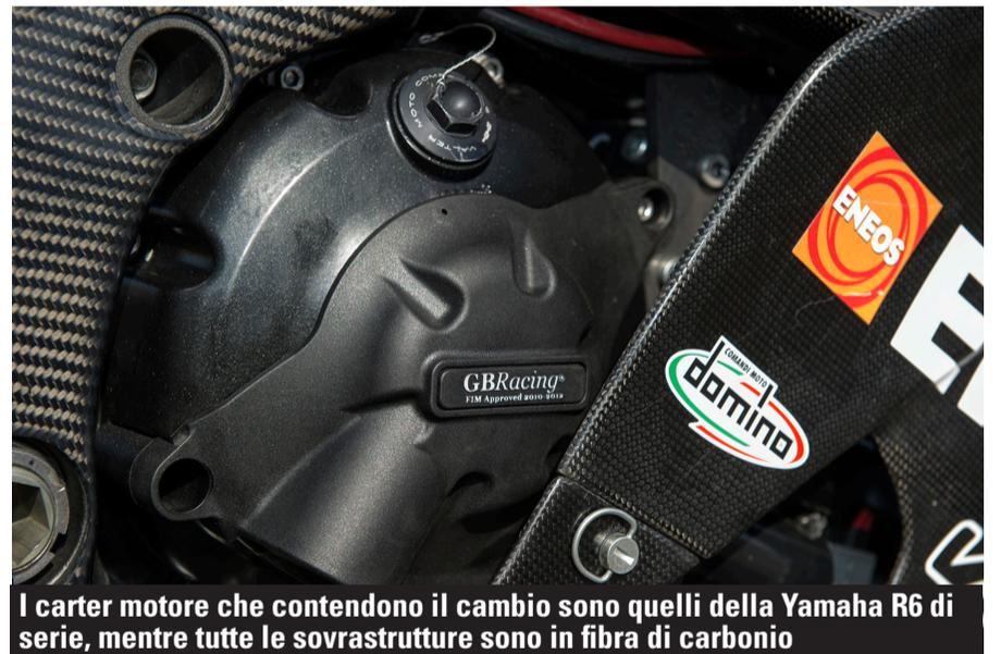
I carter motore che contengono il cambio sono quelli della Yamaha R6 di serie, mentre tutte le sovrastrutture sono in fibra di carbonio
