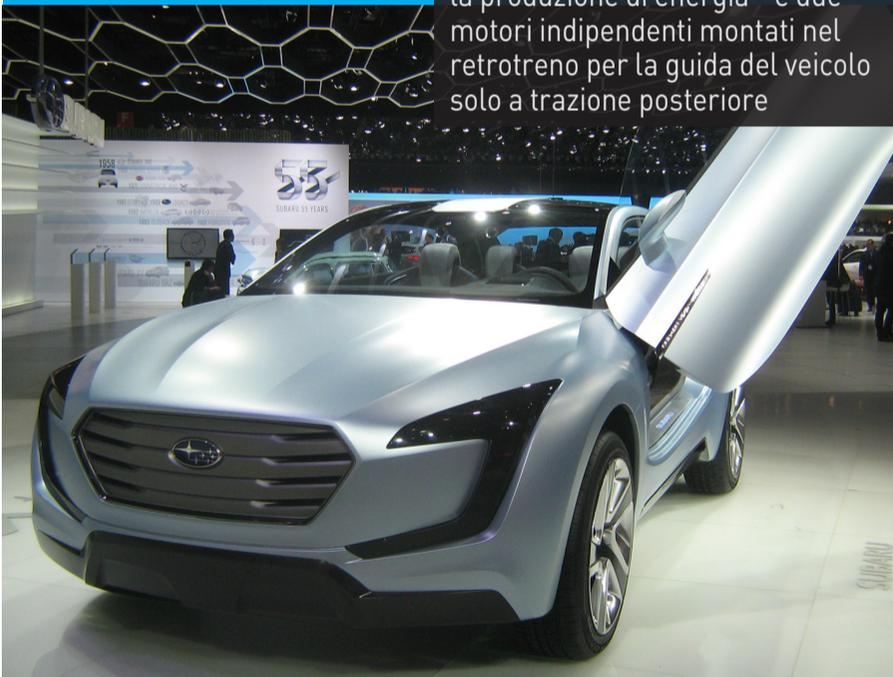
**Subaru Concept Viziv** possiede un sistema ibrido che combina un 2.0 litri Subaru Boxer Diesel con una coppia elevata compatibile con il cambio Lineartronic (CVT) con un motore anteriore - che fornisce sia la trazione del veicolo che la produzione di energia - e due motori indipendenti montati nel retrotreno per la guida del veicolo solo a trazione posteriore
