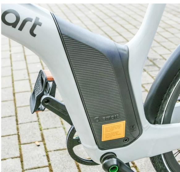
La batteria completamente integrata nella struttura portante
