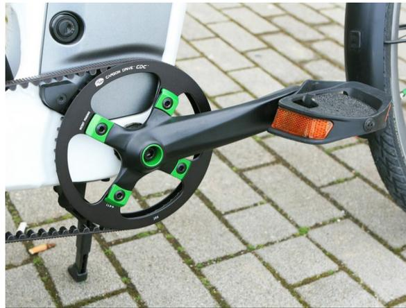
Trasmissione a cinghia in fibra di carbonio. Nell'immagine si nota anche la chiave per staccare la batteria. Un deterrente al furto
