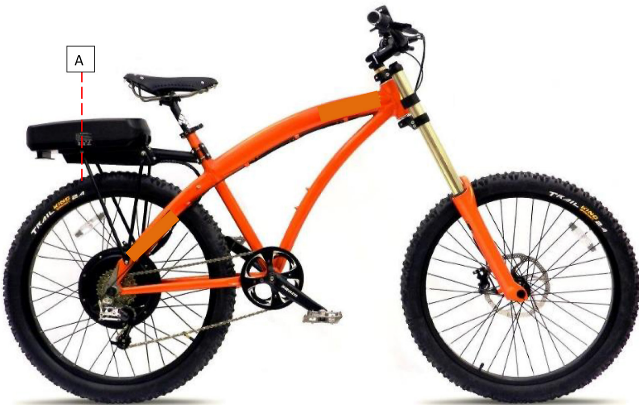
Figura 3 La metà posteriore di questa batteria sporge a sbalzo, sottoponendo il supporto a facili rotture
