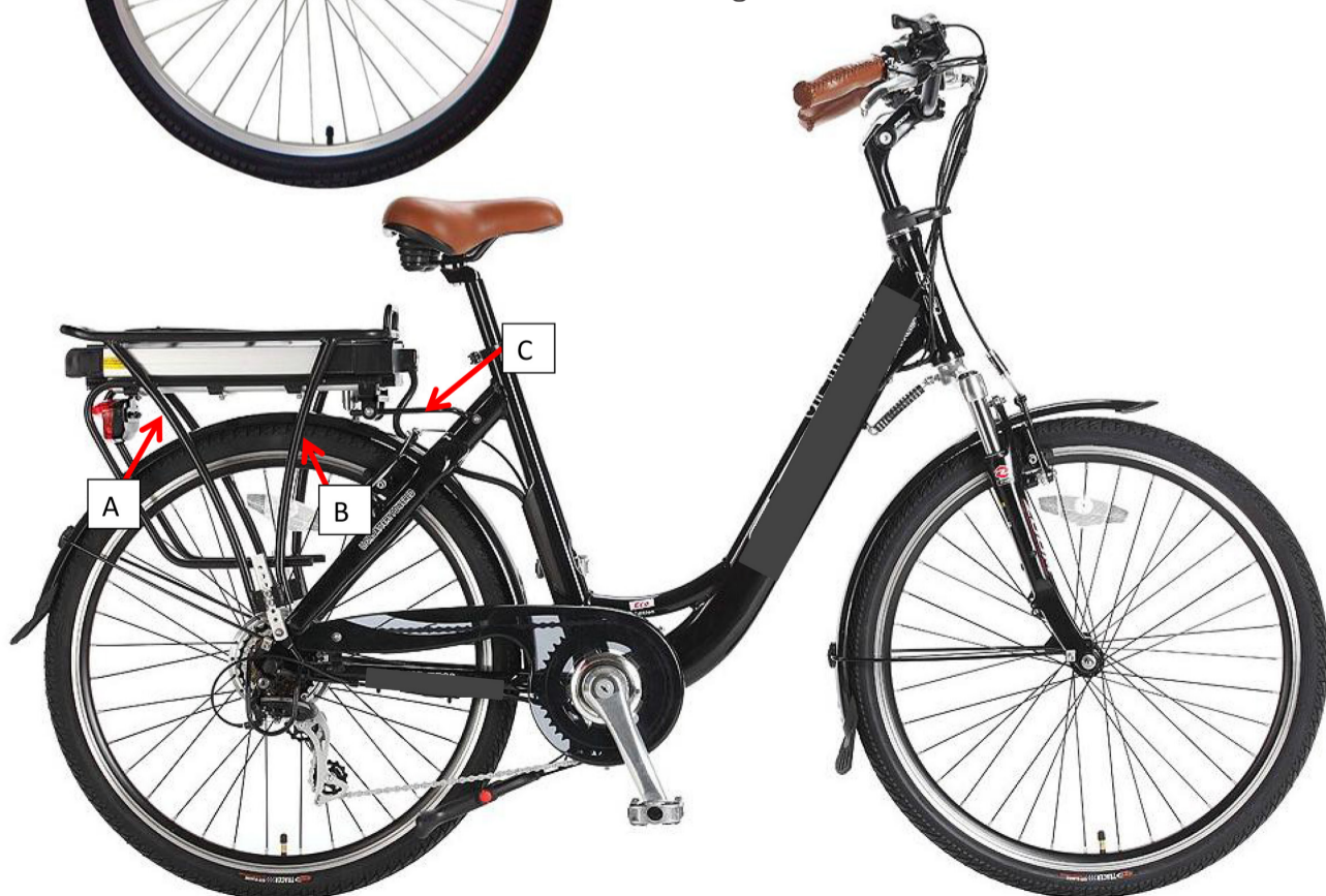
Figura 2 In questa posizione, il supporto è meno soggetto a rotture in quanto la batteria è vincolata da entrambi i lati
