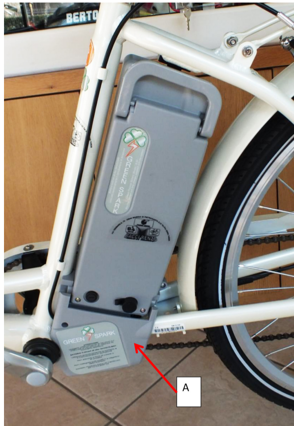
Figura 5 e 6 Quando la batteria è posizionata sul tubo piantone, la parte maggiormente soggetta a sollecitazioni è quella del supporto inferiore
