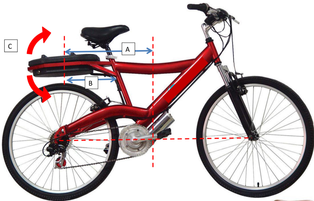
Figura 1 In questa posizione la batteria è soggetta a numerose sollecitazioni che possono portare a rottura del supporto
