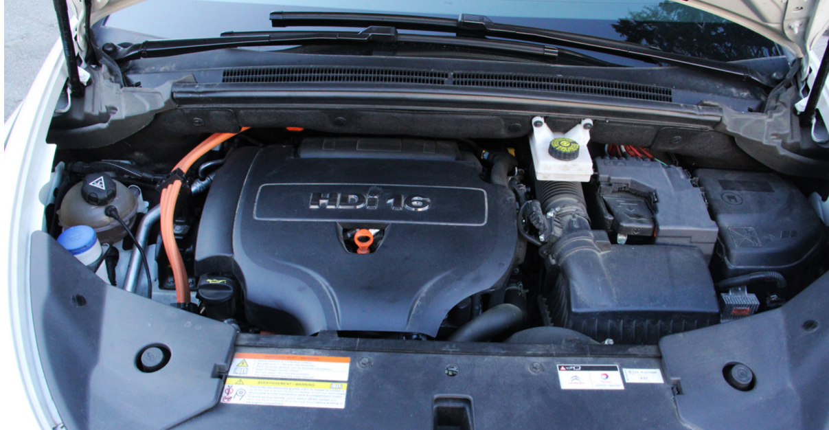
La copertura del motore Hdi due litri: gli organi ausiliari sulla destra (tra i quali la batteria tradizionale) e sulla sinistra i cavi ad alta tensione che collegano l'alternatore reversibile alle componenti elettriche del sistema ibrido
