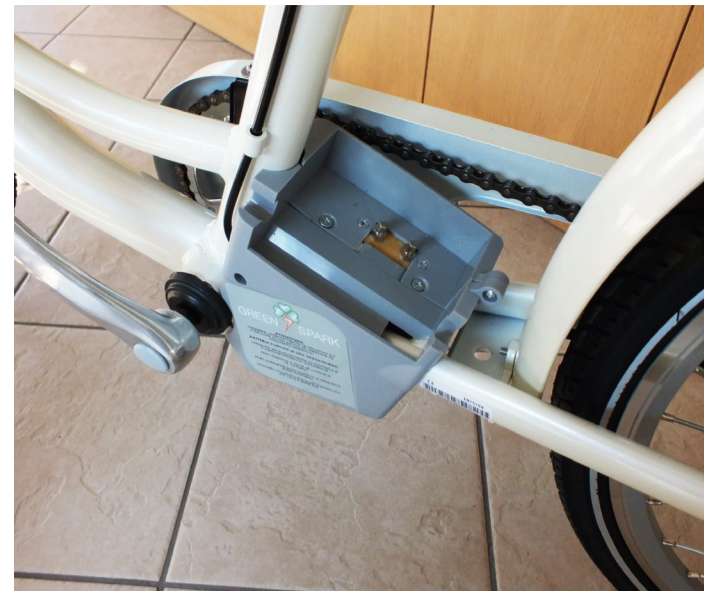
Figura 5 e 6 Quando la batteria è posizionata sul tubo piantone, la parte maggiormente soggetta a sollecitazioni è quella del supporto inferiore
